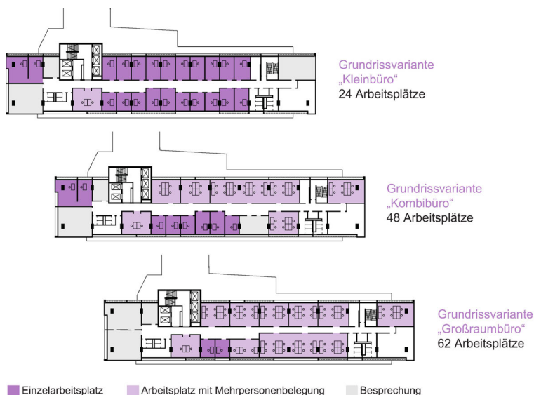
Abbildung 34: Exemplarische Darstellung der drei Grundrissvarianten »Kleinbüro« (oben), »Kombibüro« (Mitte) und »Großraumbüro« (unten) (BBSR, eigene Darstellung)
