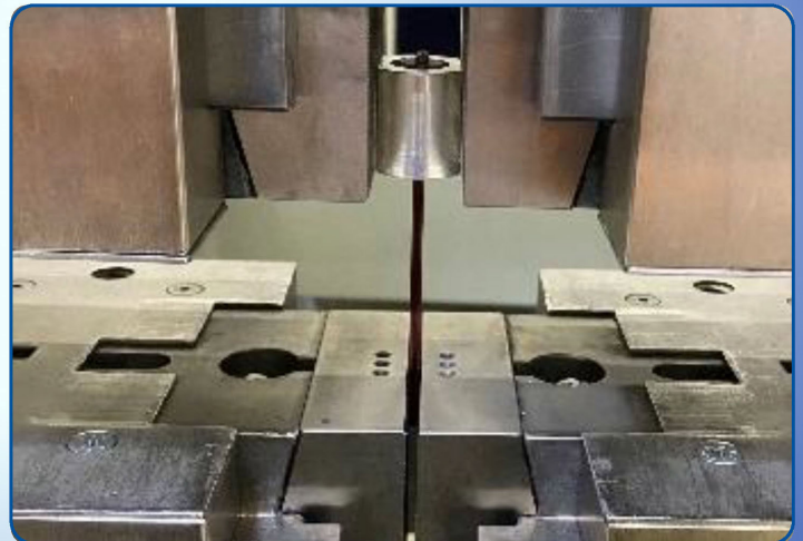
Messung der Anhaftung der Imprägnierung
