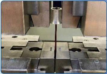
Messung der Anhaftung der Imprägnierung
