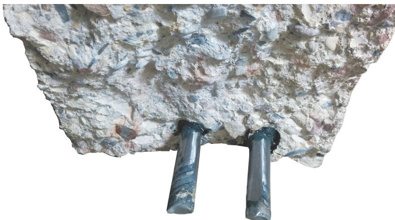
Abbildung 7.15: Gerissene Bewehrung des Stahlbetonbalkens
