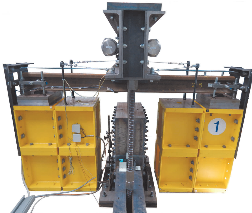
Abbildung 7.3: Realisierter Versuchsstand zur Untersuchung des Ermüdungsverhaltens von Eisenbahnschienen
