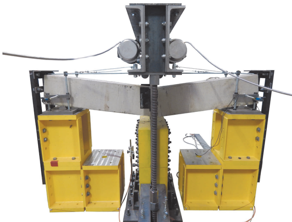
Abbildung 7.11: Realisierter Versuchsstand zur Untersuchung des Ermüdungsverhaltens von Stahlbetonbalken im Very-High-Cycle-Fatigue-Bereich (nach Versuchsende)
