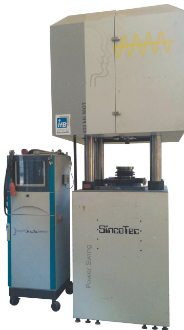
(a) Resonanzprüfmaschine des Instituts für Baustoffe an der Leibniz Universität Hannover vom Typ Power Swing der Firma SincoTec
