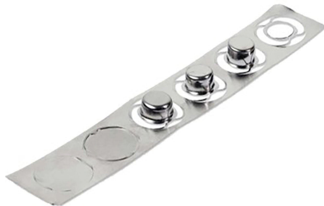
Bild 1. Blechstreifen mit Stadienfolge aus einem Folgeverbundwerkzeug. Foto: [1]
