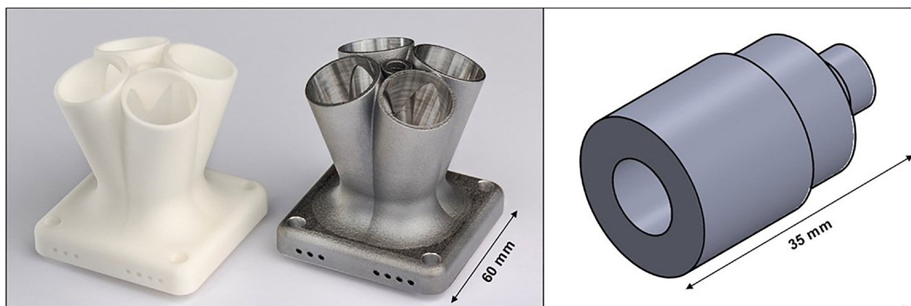
Bild 1 Links: Krümmersammler aus PA-12 und AlSi10Mg. Rechts: Drehteil aus AlSi10Mg. Grafik: PTB Braunschweig
