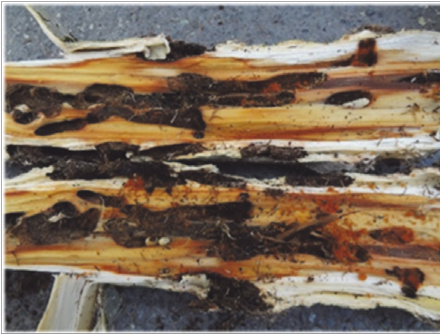
Abb. 4: Holzerstörung durch Anoplophora glabripennis
