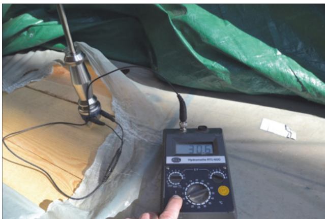
Abb. 11: Holzfeuchte Einzelwerte > Fasersättigung ermittelt über das Widerstandsverfahren mit der GANN RTU 600 (DREGER, 2017)
