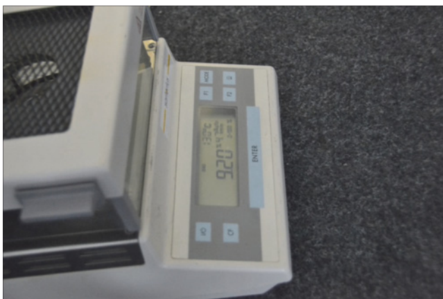
Abb. 17: Holzfeuchten (Masseprozent) können unmittelbar am Gerät abgelesen werden (DREGER, 2017)
