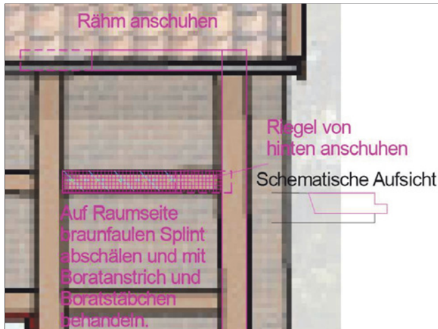
Abb. 7: Skizze aus einem Sanierungsvorschlag mit schräg hinterschnittenem Reparaturstück eines Riegels.
