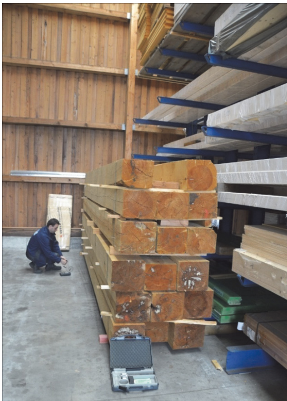
Abb. 18: Einzelwerte bis 25 m% waren nicht wirklich befriedigend, gut erkennbar die Ausharungen nach erneuter Trocknung (DREGER, 2017)
