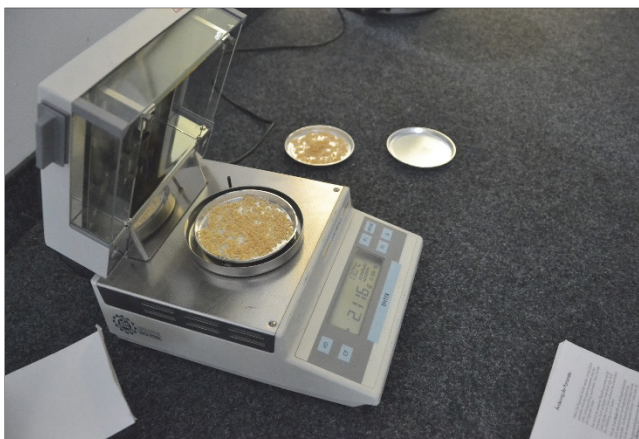
Abb. 16: Eine Späneprobe wird gewogen und anschließend auf Massegleichgewicht getrocknet (DREGER, 2017)
