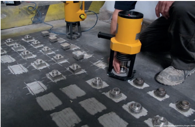
Bild 6 Ermittlung Oberflächenzug- und Haftzugfestigkeit
