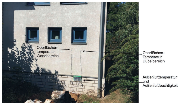
Bild 3 Messaufbau für WDVS-Bestandsobjekte zur Langzeitdatenerfassung
