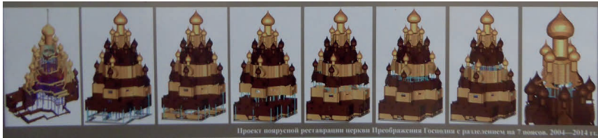
Bild 5 Modellerte Darstellung der Restaurierungsabschnitte mit dem jeweils angehobenen Teil der Kirche.
