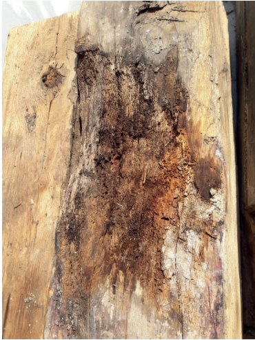
Bild 10 Würfelbruch im Holz
