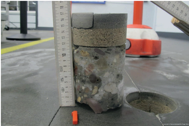
Bild 4 Bohrkernentnahmen aus Industrieboden
