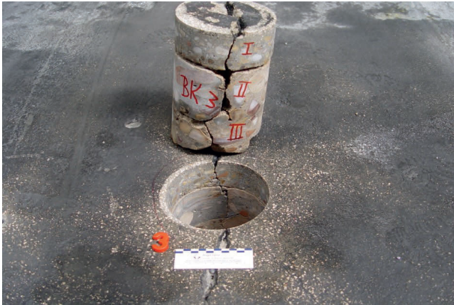
Bild 3 Bohrkernentnahmen aus Industrieboden
