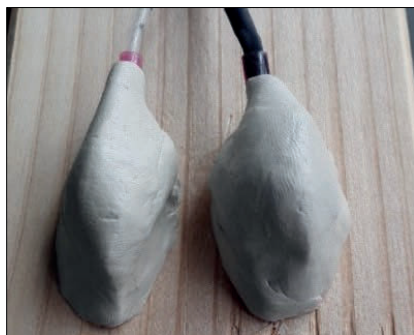
Bild 20 Elektrodenköpfe mit Plastic-Fermit abgedichtet [1]
