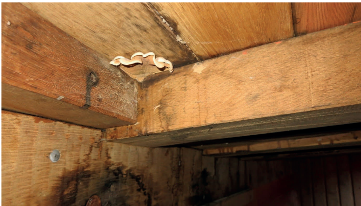
Bild 19 Fruchtkörper Muschelkrempling unter Deck an den Spanten aus Eiche
