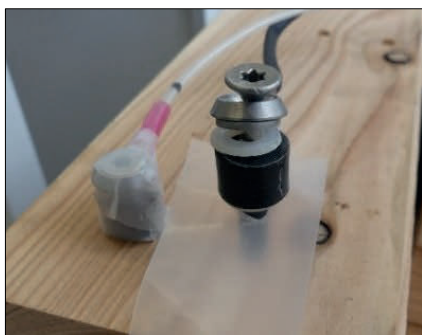
Bild 19 Elektrodenköpfe mit Parafilm abgedichtet [1]
