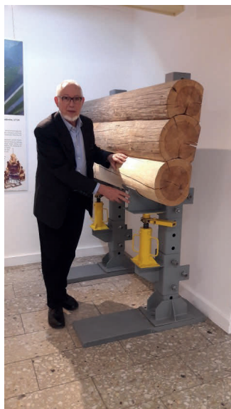
Bild 6 Der Autor bei der Demonstration des Liftingsystems im Maßstab 1:1
