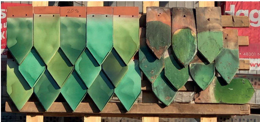
Bild 13 Probееindeckung mit den neuen und alten Dachziegeln
