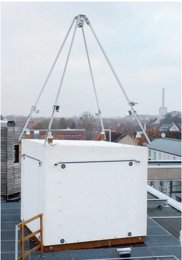
Bild 4 Teststand zur Untersuchung des Feuchteanfalls und der Bewuchsentwicklung
