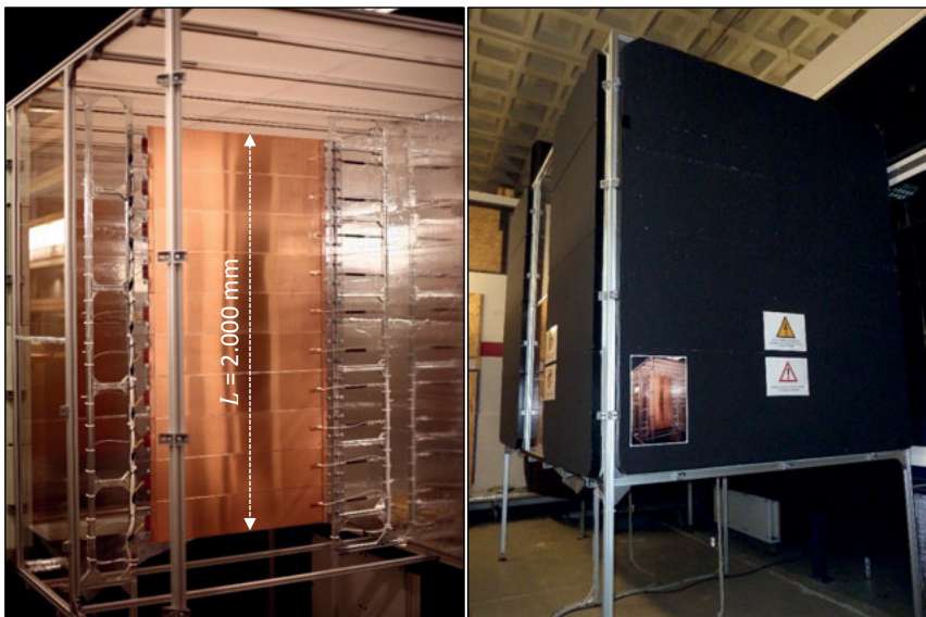
Abbildung 3.1: Strömungsmechanische Abschirmung der beheizten Platte (links: geöffnete Abschirmung; rechts: geschlossener Zustand)
