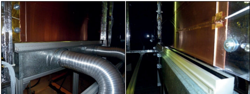
Abbildung 4.1: Dampf-Einbringung zur Strömungsvisualisierung
