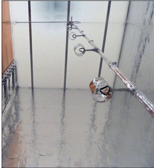
Abbildung 3.9: Strahlungsabschirmung der Lufttemperatursensoren
