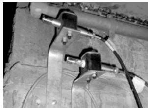
Bild 4.11: Anbringung der Mikrophone (Typ 4189, Herstellers Bruel & Kjaer)
