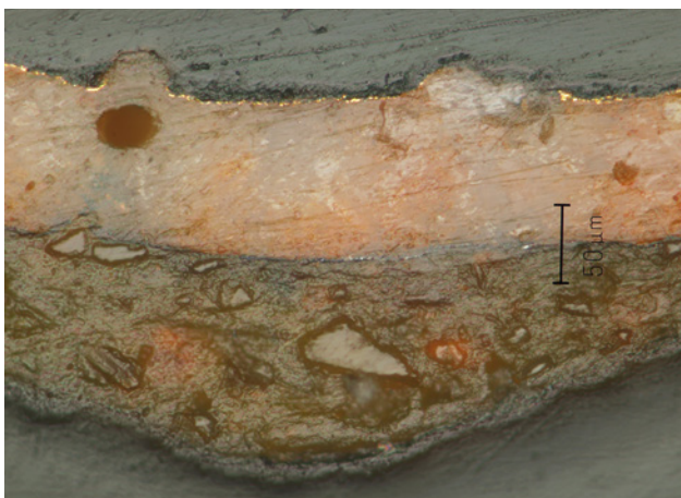
Abb. 23 Fassungsprobe P1/Querschliiff Sonne. Erstfassung: 1a Grundierung: gelber Bolus, 1b Metallauflage, Zweitfassung: 2a Grundierung: Mixture (u. a. Massikot enthaltend), 2b Metallauflage goldfarben (Gold)
