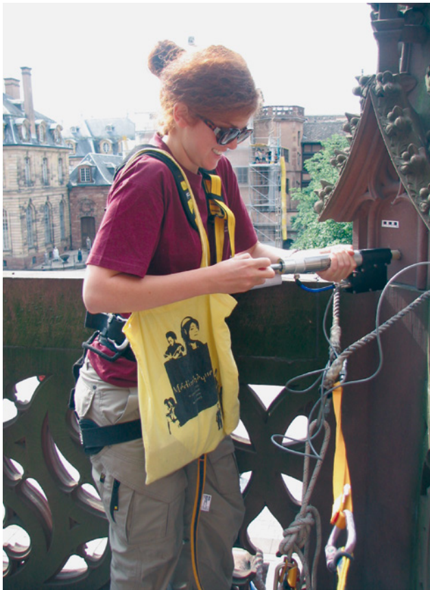
Abb. 7 Zerstörungsfreies Verfahren für die Messung der Luftdurchlässigkeit des Sandsteins
