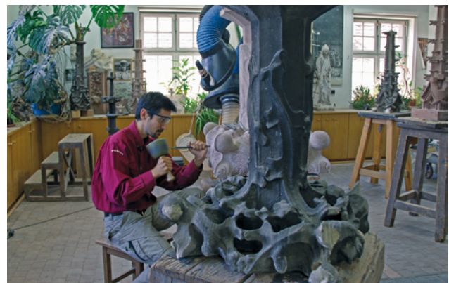
Abb. 5 Anfertigung einer Kopie einer Kreuzblume in der Bildhauerwerkstatt
