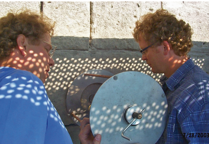
Bild 1 Haftzugsmessung an Schlämmen
