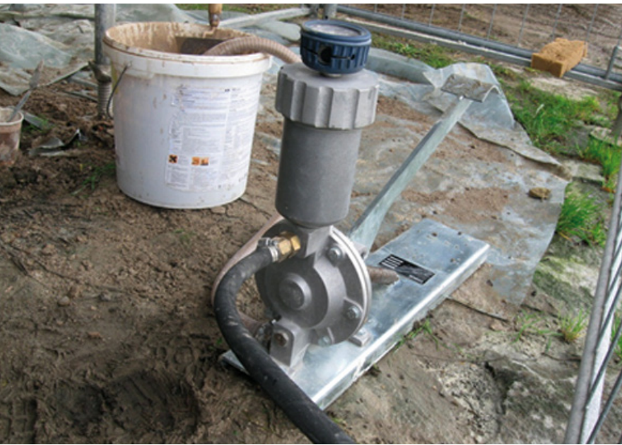
Bild 3 Handpumpe zum Einbringen von Verpressgut
