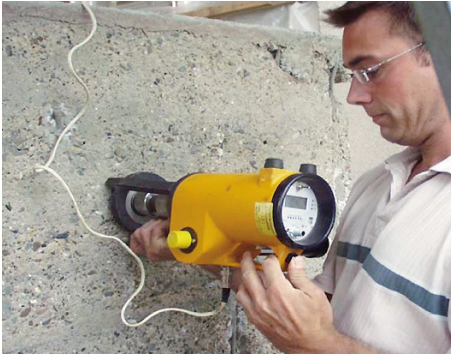
Bild 2.121 Bestimmung der Oberflächenzugfestigkeit an einer Wand
