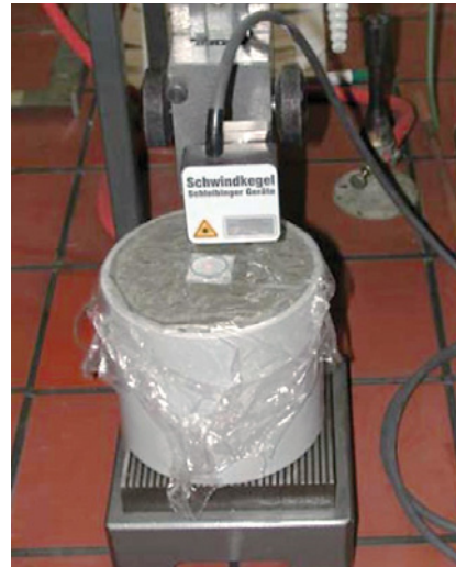
Bild 2.44 Schwindkegel zur Messung des frühen autogenen Schwindens (aus [2.75])
