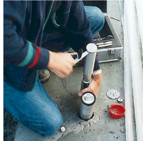
Bild 2.116 Durchführung des Lok-Tests auf einer Geschossdecke [2.195]
