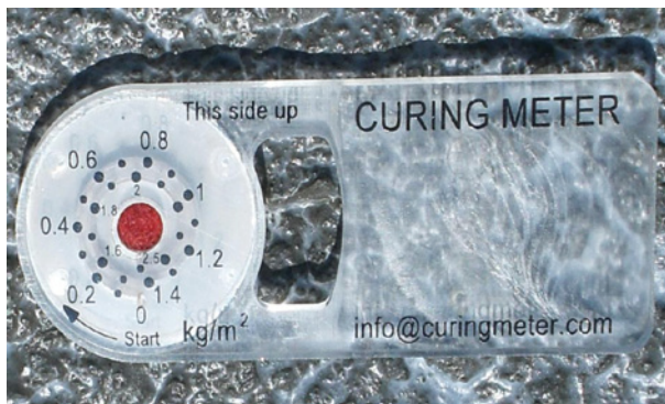
Bild 2.52 Curing Meter zur Bestimmung der Verdunstungsmenge an der Bauteiloberfläche.
