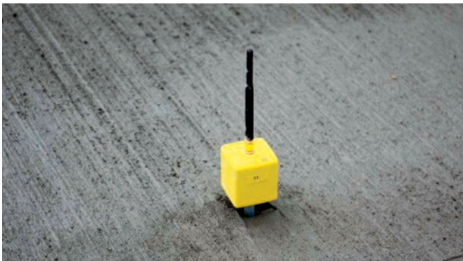
Bild 2.12 Funksensor zur Erfassung des Kapillardruckes [2.20], in die Betonoberfläche eingesteckt
