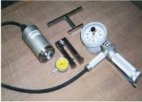
Bild 2.119 Break-off Tester zur Abschätzung der Betonfestigkeit
