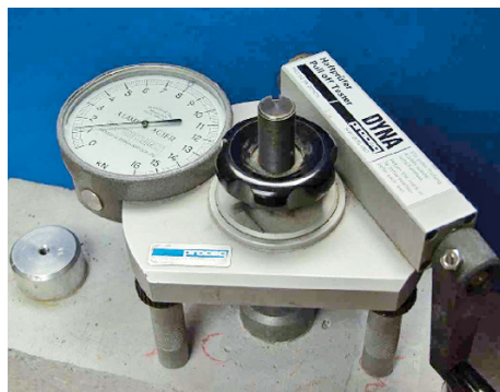
Bild 2.120 Oberflächenzugprüfgerät mit Haftzugsstempel und digitaler Anzeige
