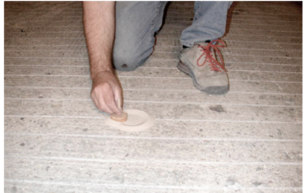
Bild 3.40: Messung der Rautiefe mit dem Sandfleckverfahren, kreisförmiges Verteilen des Sandes
