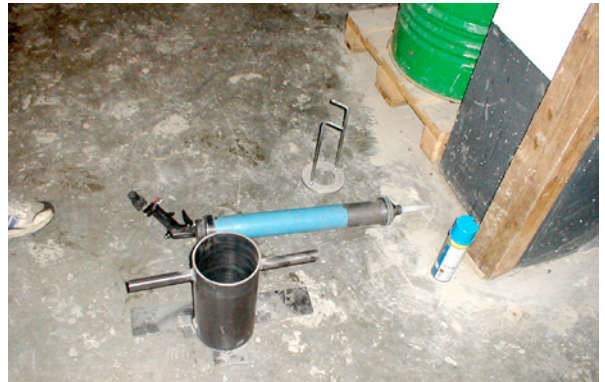
Bild 5.177: Druckluftgesteuerte Kleberpistole und Mischgefäß
