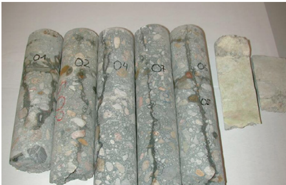
Bild 5.11: Bohrkerne mit wasserführenden Trennrissen
