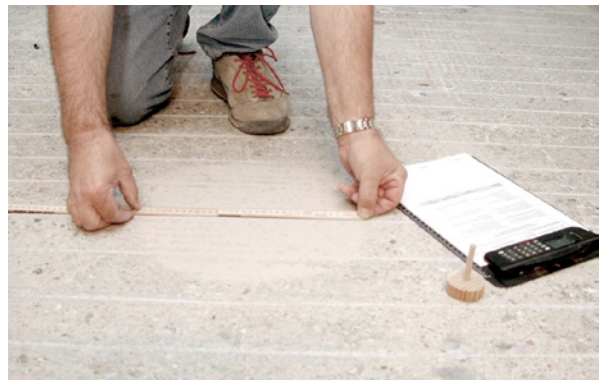
Bild 3.41: Messung der Rautiefe mit dem Sandfleckverfahren, Messung des Durchmessers des Sandfleckes als Grundlage zur Berechnung der Rautiefe
