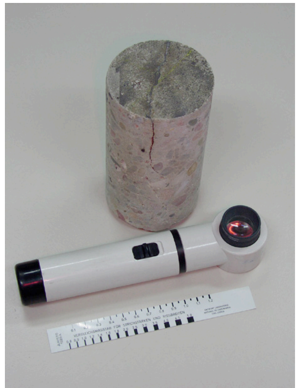
Bild 5.7: Die Ausgangsrisssbreite wird mittels Rissbreitenmaßstab bzw. Risslupe gemessen. Die Feststellung des Rissverlaufs im Bauteil bedarf der Entnahme von Bohrkernen.
