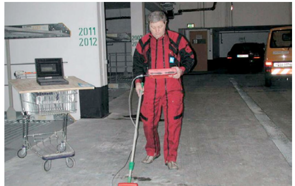
Bild 5.8: Zur Vorbereitung und Durchführung von Instandsetzungsarbeiten an Parkdecks und in Tiefgaragen ist die flächendeckende Aufnahme (i. d. R. durch wirksame zerstörungsfreie Prüfungen) der Betondeckung wichtig.
