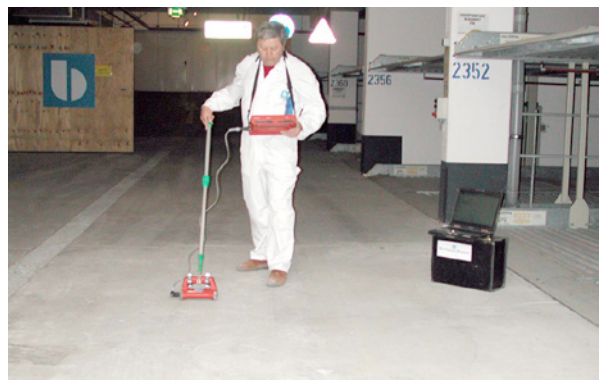
Bild 3.49: Zerstörungsfreie Messung der Betondeckung mit HILTI Ferroskan, Aufnahme eines Linienscans
