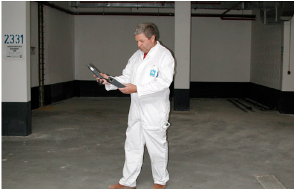
Bild 3.37: Messung der Raumlufttemperatur und relativen Raumluftfeuchte vor Arbeitsbeginn typischer Rissbildung an den Stützenkanten
