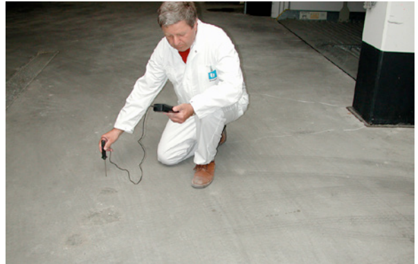
Bild 3.38: Messung der Bauteiloberflächentemperatur, zur Bewertung der Kondensation infolge Erreichen bzw. Unterschreiten der Taupunkttemperatur
