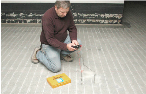
Bild 3.42: Messung der Bauteilfeuchte der oberflächennahen Betonschicht mit dem elektronischen Feuchtemessgerät (EFM)
