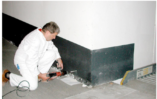
Bild 3.47: Bohrmehlentnahme zur Untersuchung des Chloridgehaltes im Sockelbereich
