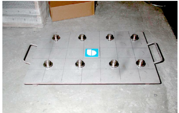
Bild 5.190: Stahlplatte zum Nachweis der Kleberfestigkeit
