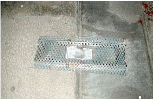
Bild 3.10: Messung der Rissbreitenänderung mit einem Rissmonitor
