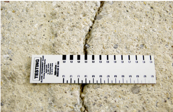
Bild 3.9: Messung der Rissbreite an einer mit festen Strahlmitteln gestrahlten Bauteiloberfläche mit dem Strichmaß
