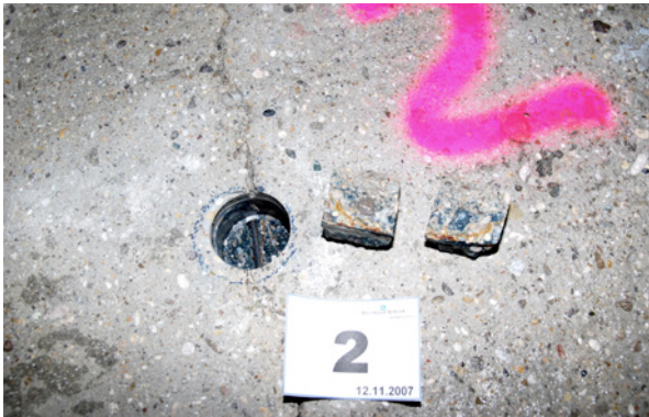
Bild 3.46: Bohrkerneentnahme an einem oberflächennahen Riss. Der Riss verläuft genau über einer oberen Bewehrung, die Bewehrung zeigt Korrosionsspuren von chloridinduzierter Bewehrungskorrosion.
