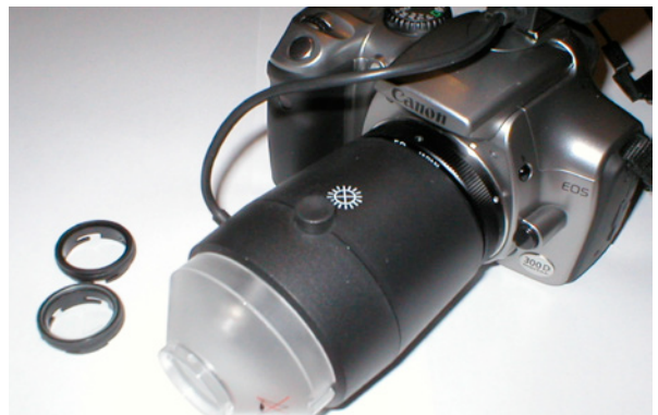
Bild 5.14: »Risskamera« zur Dokumentation und Messung der Rissbreite (Dokument siehe Bild 5.13)
