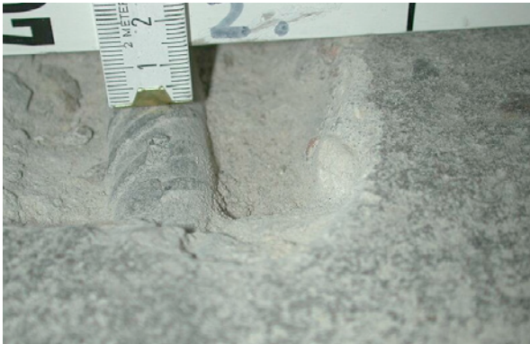
Bild 5.9: Zur exakten Ermittlung der Betondeckung ist eine geringe Anzahl von zerstörenden Prüfungen notwendig. Hierbei wird die Prüfung des Bewehrungsdurchmessers und die Beurteilung des Korrosionszustandes möglich.
