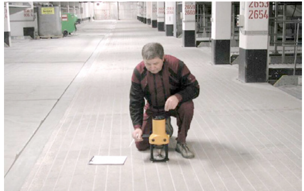
Bild 5.197: Prüfung der Oberflächenzugfestigkeit
