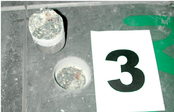
Bild 5.189: Nachweis der Verbundfestigkeit zwischen Mörtelschicht und Unterbeton
