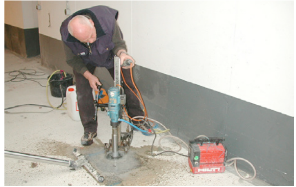
Bild 5.10: Bohrkernentnahme an ausgewählten Rissen zur Feststellung des Rissverlaufs im Bauteil
