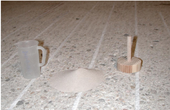
Bild 3.39: Messung der Rautiefe mit dem Sandfleckverfahren auf einer feststoffgestrahlten Betonfläche, Aufbringen einer bestimmten Sandmenge (25 bzw. 50 cm³; Quarzsand, Körnung 0,1–0,5 mm)
