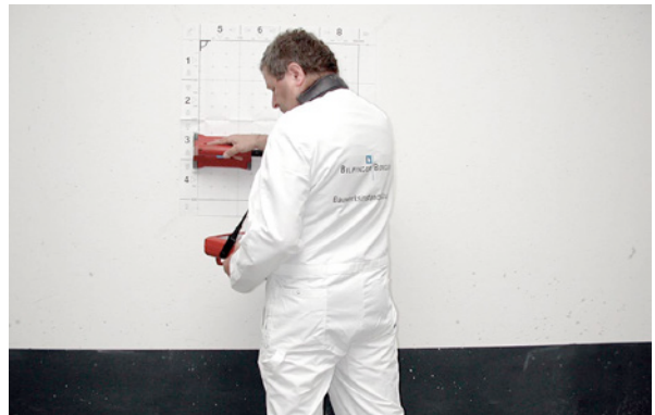
Bild 3.48: Zerstörungsfreie Messung der Betondeckung mit HILTI Ferroskan, Flächenaufnahme
