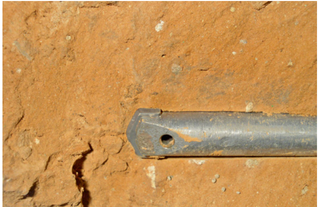
Bild 60 Druckluftunterstützter Bohrer (Bildquelle: Mauersägetechnik Georgy, Blankenhain)
