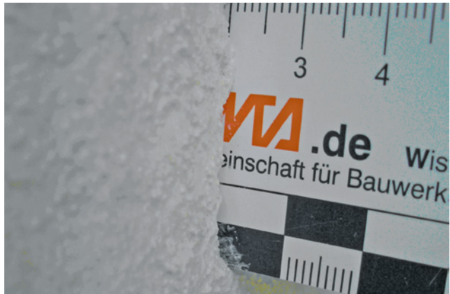
Bild 82 Sanierputz als Schutzschicht auf Innenabdichtung (Bildquelle: Fa. Dirk Hünninghaus, Wuppertal)
