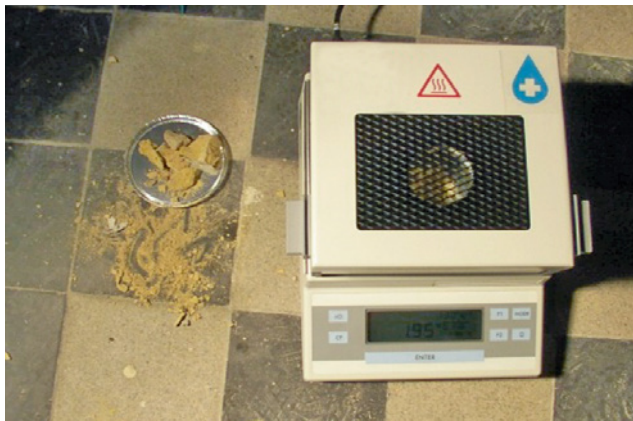
Bild 25 Mobiles Infrarot-Darrgerät (Bildquelle: Otto Richter GmbH)
