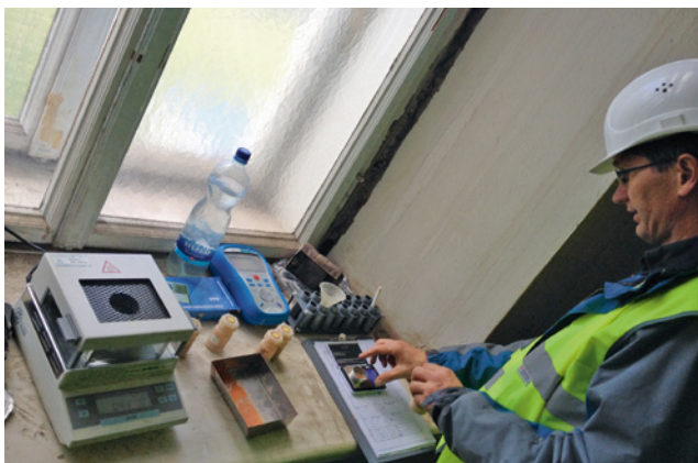
Bild 23 Probennahme und Feuchtemessung (mobiles Darrgerät) vor Ort (Bildquelle: Otto Richter GmbH)
