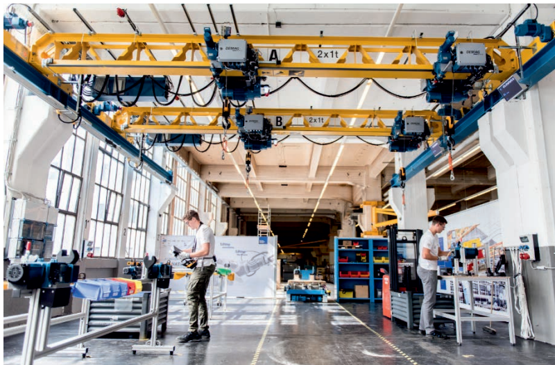
Bild 3: Material Handling Demonstrator in der DEMAG Research Factory
