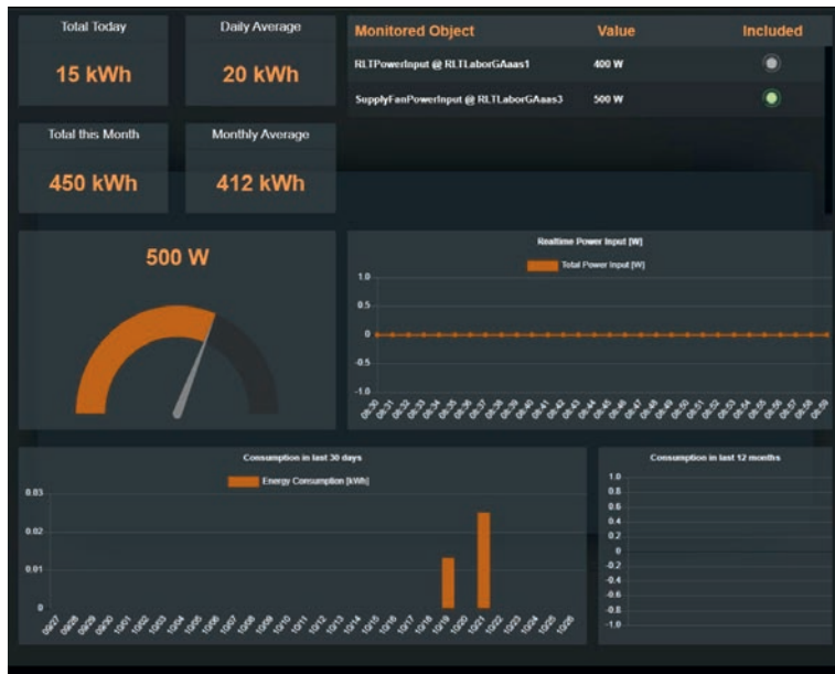
Bild 5: Beispiel für Energiemonitoring der ausgewählten RLT-Anlage, Screenshot aus entwickelter Plattform
