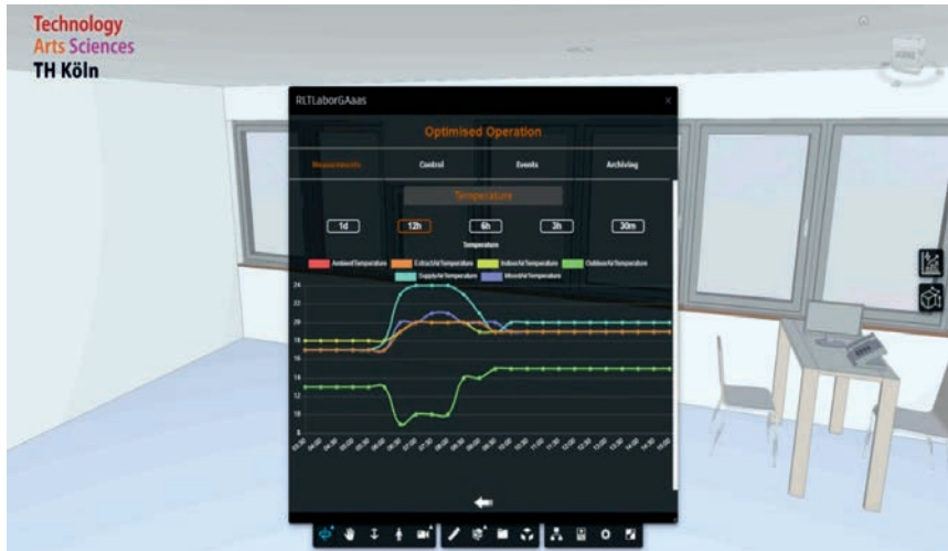
Bild 4: Beispiel für das Auslesen der verschiedenen Lufttemperaturen der ausgewählten RLT-Anlage, Screenshot aus entwickelter Plattform
