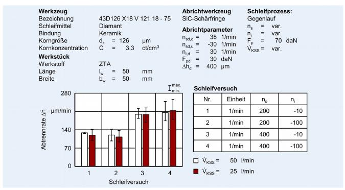
$\textbf{Bild 8}. \ Einfluss \ des \ KSS-Volumenstroms \ V_{KSS} \ auf \ die \ Abtrennrate \ \Delta h \ bei \ variierenden \ Prozessparametern. \ \textit{Grafik: IFW}$
