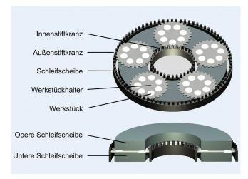
**Bild 1.** Hauptkomponenten beim Doppelseitenplanschleifen mit Planetenkinematik [2]. *Grafik: IFW*
