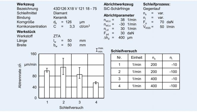
Bild 3. Einsatzverhalten vollflächiger Schleifscheiben. Grafik: IFW
