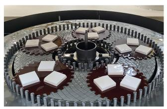
Bild 2. Versuchsaufbau mit vollflächiger Schleifscheibe vs. strukturierter Schleifscheibe. Grafik: IFW
