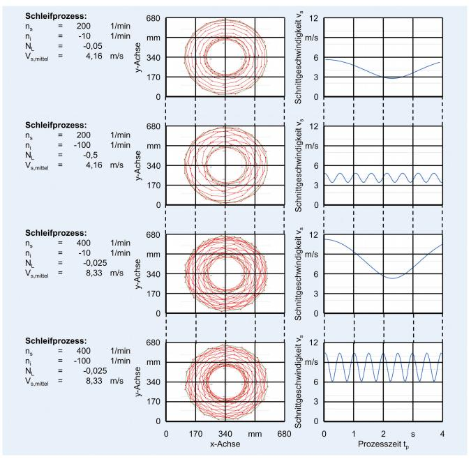
**Bild 4.** Zykloide Bewegungsbahnen der Werkstücke über die Schleifscheibenoberfläche sowie die mittlere Schnittgeschwindigkeit v<sub>s,mittel</sub> in Abhängigkeit der Prozessparameter. *Grafik: IFW*
