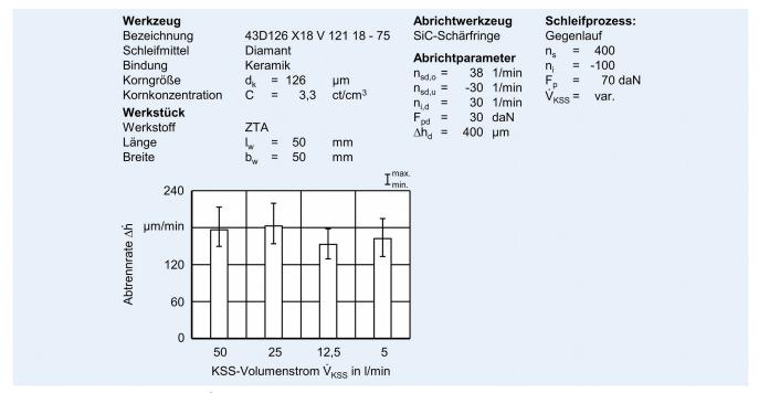
$\textbf{Bild 9}. \ Einfluss \ des \ KSS-Volumenstroms \ \dot{V}_{KSS} \ auf \ die \ Abtrennrate \ \Delta \ddot{h} \ bei \ der \ Verwendung \ von \ strukturierten \ Schleifscheiben. \ \textit{Grafik: IFW}$
