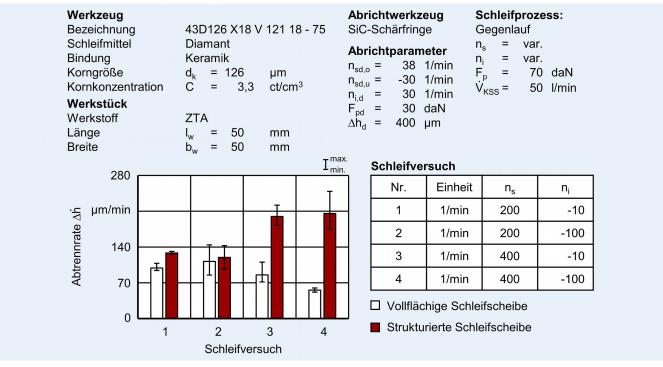
Bild 7. Einsatzverhalten strukturierter Schleifscheiben. Grafik: IFW
