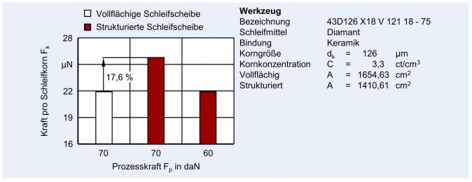
Bild 6. Einfluss der Schleifbelagsstrukturierung auf die lokale Kornbelastung. Grafik: IFW
