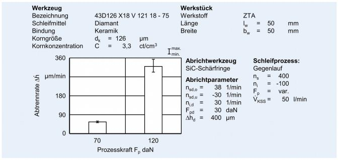
**Bild 5.** Einfluss der Prozesskraft Fp auf die mittlere Abtrennrate  $\Delta h$ . *Grafik: IFW*
