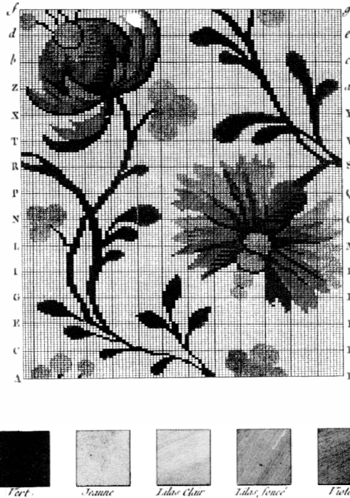
Abb. 5: Patrone oder Mis en carte für einen Brokatstoff. Quelle: Denis Diderot u. Jean Le-Rond d’Alembert, Encyclopédie, ou dictionnaire raisonné des sciences, des arts et des métiers , Paris 1751-80, Artikel ‚Soie‘, Band XV, Neuchatel 1765, Tafel LXII.
