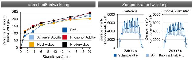
Bild 4 Einfluss der Räumöleigenschaften auf den Werkzeugverschleiß und die Zerspankraft. Grafik: [26], MTI
