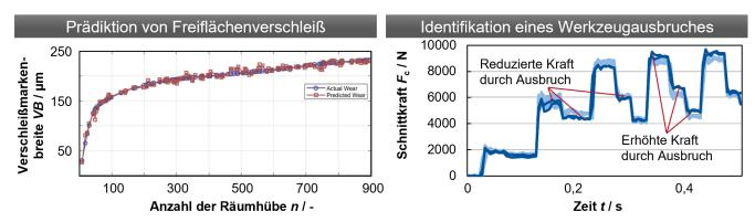
Bild 3 Bewertung des Werkzeugzustandes durch indirekte Prozessüberwachungssysteme. Grafik: MTI
