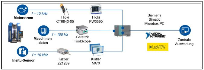
Bild 2 Prozessüberwachungssysteme zur Bewertung des Werkzeugverschleißzustandes. Grafik: MTI
