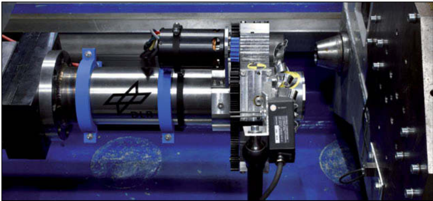
Bild 8: Proof of Concept – Aktiver Energieabsorber nach dynamischem Versuch
