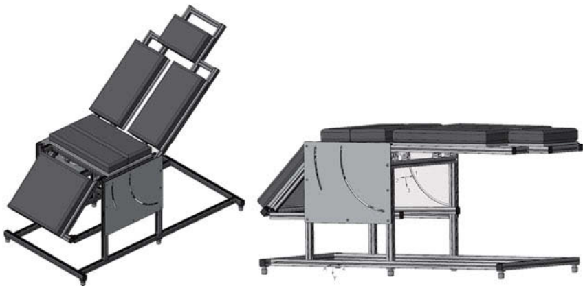
Bild 6: frei einstellbarer Ersatzsitz
