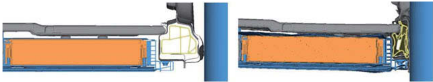
Bild 5: Schnittdarstellung durch den undeformierten (links) und deformierten Schweller (rechts)
