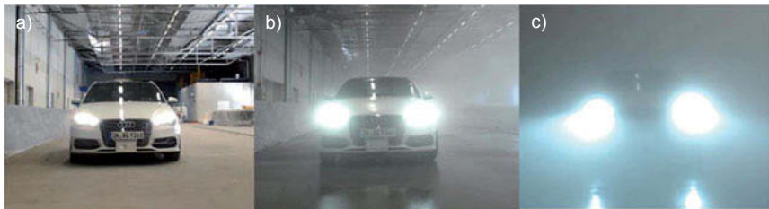
Bild 7: Kameraaufnahmen bei verschiedenen Nebelstärken a) trocken b) Nebel mit Sichtweite von 50 m c) Nebel mit Sichtweite von 10 m
