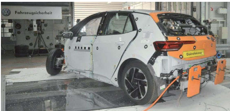
Bild 7: Fahrzeugdeformation eines ID.3 nach einem seitlichen Pfahlaufprall nach [2]
