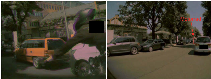
Bild 3: Standbild aus Systemvideo (Frontkamera) zum unmittelbaren Kollisionszeitpunkt (links) und Sichtverdeckung durch VW Touran in der Annäherung aus Sicht nach vorne gerichtete Flankenkamera (rechts)
