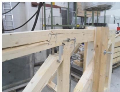
Abb. 15: Fachwerkträger (Typ 1) nach dem Versagen
