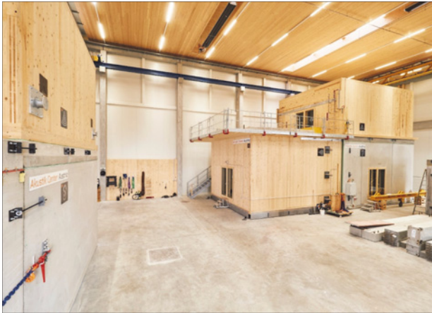
Abb. 2: XL-Schallprüfstand des Akustik Center Austria (ACA). Foto © ACR/schewig-fotodesign
