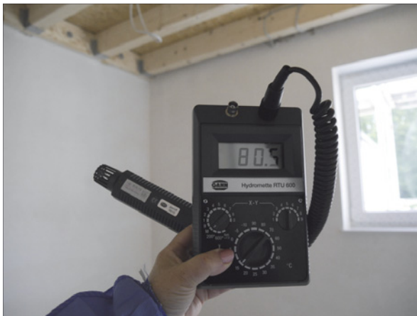
Abb. 1: ab ca. 70 % relativer Luftfeuchte liegen Lebensbedingungen für mikrobiellen Befall vor, hohe Raumluft- oder Materialfeuchten sind umgehend zu reduzieren
