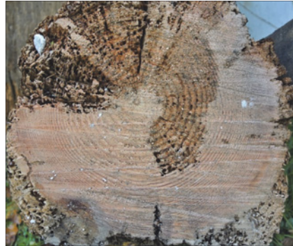
Abb. 5: Fraßbild des Gescheckten Nagekäfers an z. T. braunfaulem Kiefernholz: Vom Splintholz ist kaum etwas erhalten, so stark wurde es massiv zerstört. Das Kernholz wurde nur an den Stellen zerstört, an denen zuvor eine Fäule vorlag.
