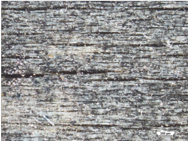
Abb. 10b: Lärchenholz mit lösemittelbasiertem Silikonharz (SHL); nach 1 Jahr Freibewitterung in GK 3.2 (M 30:1)
