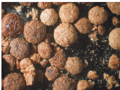
Abb. 26: Bohrmehl des Gescheckten Nagekäfers: Kotpartikel sind typisch diskus- oder linsenförmig.
