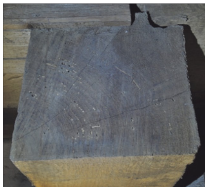
Abb. 13: Am Glockenturm wurden Hölzer gekürzt, bzw. angeschnitten um die großen Glocken in den Turm zu bringen. Die so sichtbar gewordenen Fraßgänge belegen wieder die Anwesenheit eines Schadens durch den Gescheckten Nagekäfer vor 1955. Die Fraßgänge folgen den Jahrringen.
