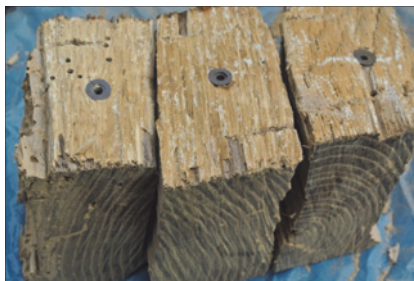
Abb. 33: Abschnitte eines Sparrens: Untersuchte Probenteile zum direkten Nachweis von Larven. In der Umgebung der Packer wurden lebende Larven nachgewiesen. Maßstab: Der Packer-Kopf ist 1,1 cm breit.
