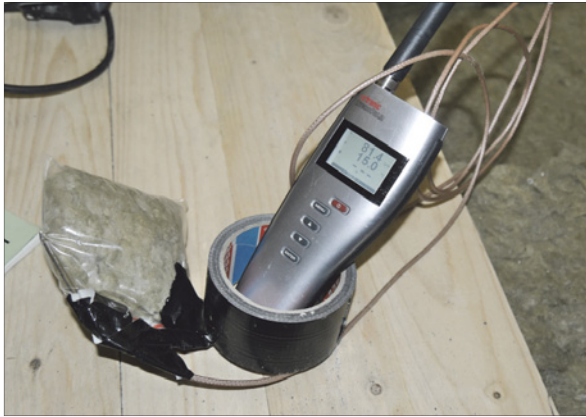
Abb. 5: hygrothermische Feuchtemessung, relative Luftfeuchte von über 80 % im Dämmstoff
