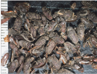
Abb. 34: Zusammengelegte Reste eines Auflagerfeldes; Käfer und Käferteile isoliert und etwas gereinigt, die Verstaubungen zeigen an, dass es sich um ältere Käferreste des Gescheckten Nagekäfers handelt.
