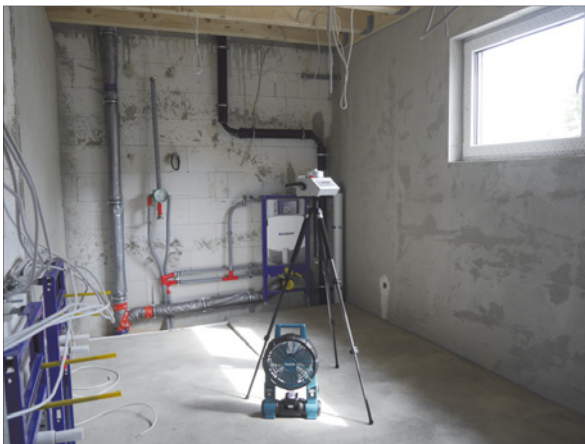
Abb. 15: Sanierungskontrolle mittels Partikelsammlung unter Beachtung [9]
