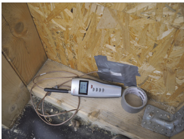
Abb. 4: hygrothermische Feuchtemessung auf der Oberfläche einer OSB-Platte
