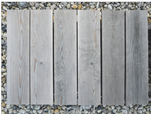
Abb. 8: Lärche mit Silikonöl, lösemittelbasiert (SOL) nach 7 Monaten Freibewitterung
