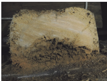
Abb. 30: Nadelholz-Schwelle; Befall mit Moderfäule und Geschecktem Nagekäfer. Entfernung zum Hausschwammsschaden: wenige Meter.
