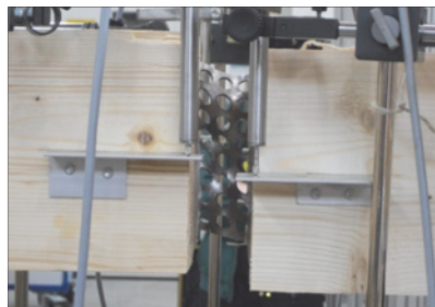
Abb. 39: Verbindung während dem Versuch, Ausbildung von Beulfeldern
