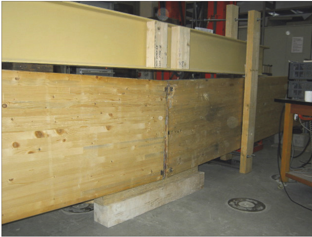
Abb. 2: Biegeträger mit Vollstoß im Versuchsstand
