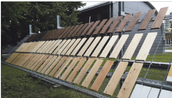
Abb. 4: Freiland-Prüfstand mit Proben in Schrägbewitterung und nordexponiert
