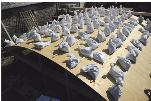
Abb. 5: Belastungsversuch mittels Sandsäcken ( F = 0,3 \text{ kN} ) am Demonstrator eines in Segmenten vorgefertigten Zöllingerdaches auf der Baustelle
