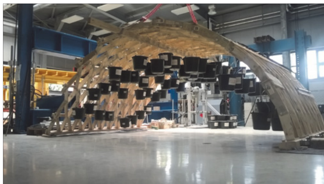
Abb. 4: Simulation einer gleichmäßig verteilten Flächenlast mittels Sandeimern ( F = 0,2 \text{ kN} ) am Großmodell in der Versuchshalle der HTWK Leipzig
