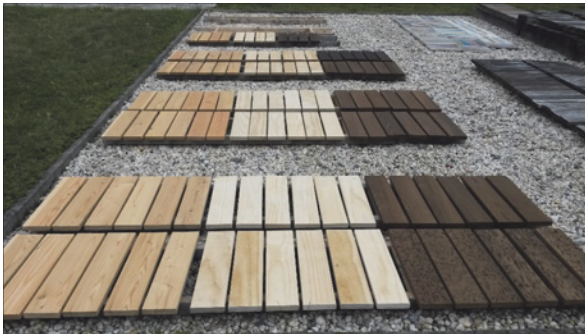
Abb. 3: Freiland-Prüfstand mit Proben in Gebrauchs-kategorie 3.2
