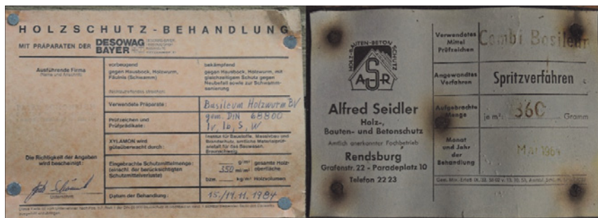
Abb. 11: Alte Dachkarten: Verwendet wurden 1964 Combi Basileum und 1985 Basileum Holzwanne BV. In einigen Bereichen der Kirche wurden 850 mg/kg Pentachlorphenol und 11 mg/kg Lindan gemessen.
