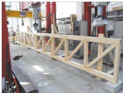
Abb. 14: Fachwerkträger (Typ 1) beim Versuchsaufbau
