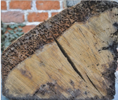
Abb. 4: Typisches Fraßbild des Gescheckten Nagekäfers an Eichen-Splintholz: Das Splintholz wurde massiv zerstört, der Kernholzanteil wurde kaum befallen. Fäule-Schäden sind durch Moderfäulepilze und Kellerschwamm in den Randbereichen vorhanden.
