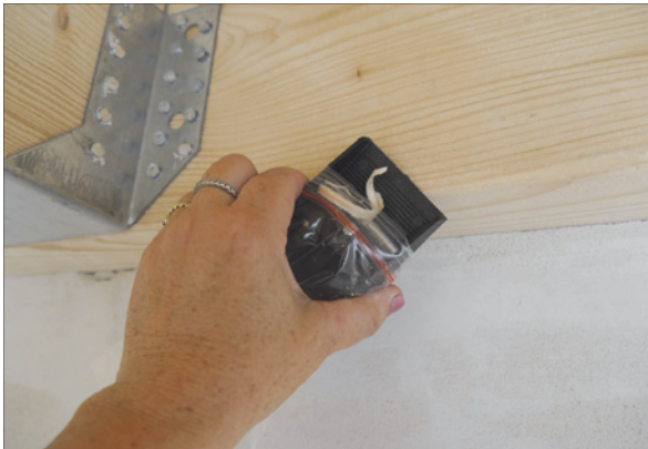
Abb. 7: Probennahme an Holzbalken
