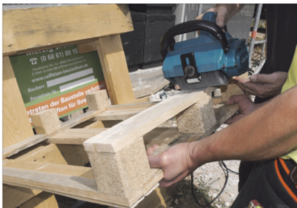
Abb. 11: Reinigung einer Vollholzoberfläche mit rotierenden Bürsten
