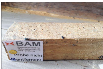
Bild 11: Holzköder aus anobiengeschädigtem Holz
