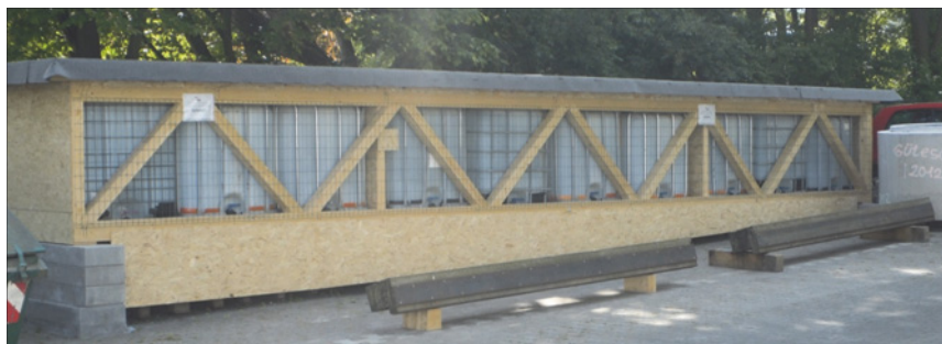
Abb. 16: Dauerstandversuch auf dem Gelände der Hochschule RheinMain
