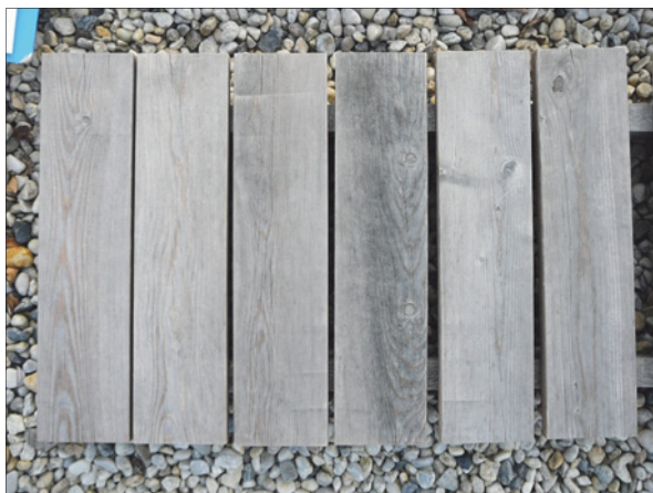
Abb. 7: Lärche mit Silikonharz, lösemittelbasiert (SHL) nach 7 Monaten Freibewitterung
