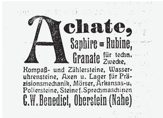
Abb. 4: Werbung für Lagersteine aus Achat. Wegen seiner im Vergleich zum Korund wesentlich geringeren Härte eignete sich dieses Mineral allerdings nur zur Fertigung von Teilen, die mechanisch nicht übermäßig beansprucht wurden, etwa Lagersteine für einfache Kompassse oder Haushaltswasserzähler.
