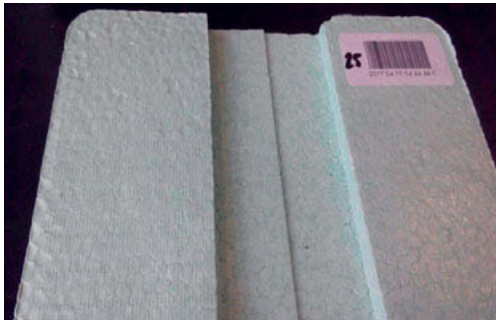
Bild 18: Beispiel eines Formteils welches mit dem Hochdruckverfahren hergestellt wurde.
