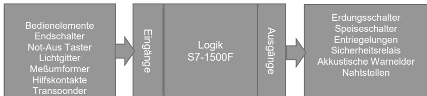
Abbildung 7: Allgemeine Darstellung der Komponenten der gesamten Steuerungskette (Quelle RPS)
