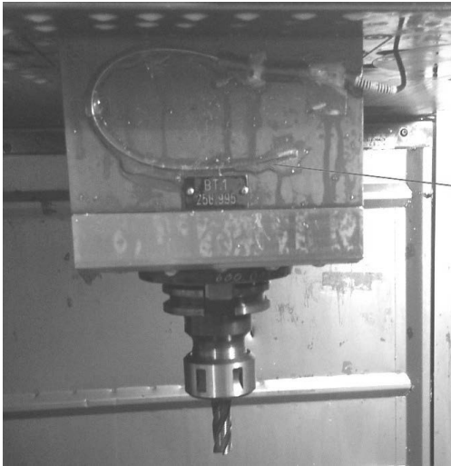
Bild 5: Eingespanntes Werkzeug mit Spindelstock und aufgeklebter Piezofaser.
