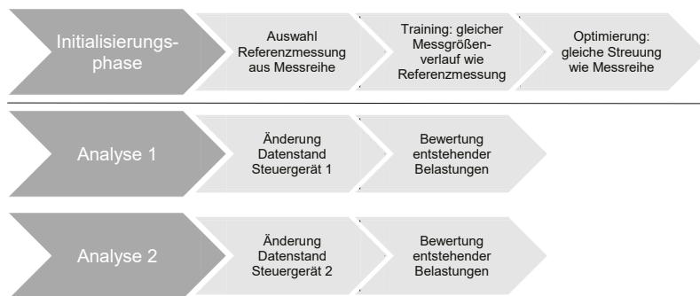
Bild 4: Vorgehen zur Bestimmung auftretender Belastungen und deren Streuung durch sich ändernde Steuergeräteparameter
