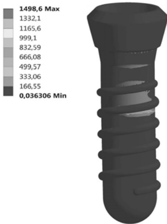
Bild 9: Von-Mises Vergleichsspannung von F=250\text{N} bei Raumtemperatur
