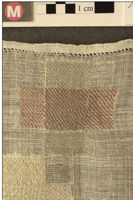
Abb. 5: Detail des Stopmüstertuches: Vervollständigung eines herausgeschnittenen Teils durch Nachweben.
