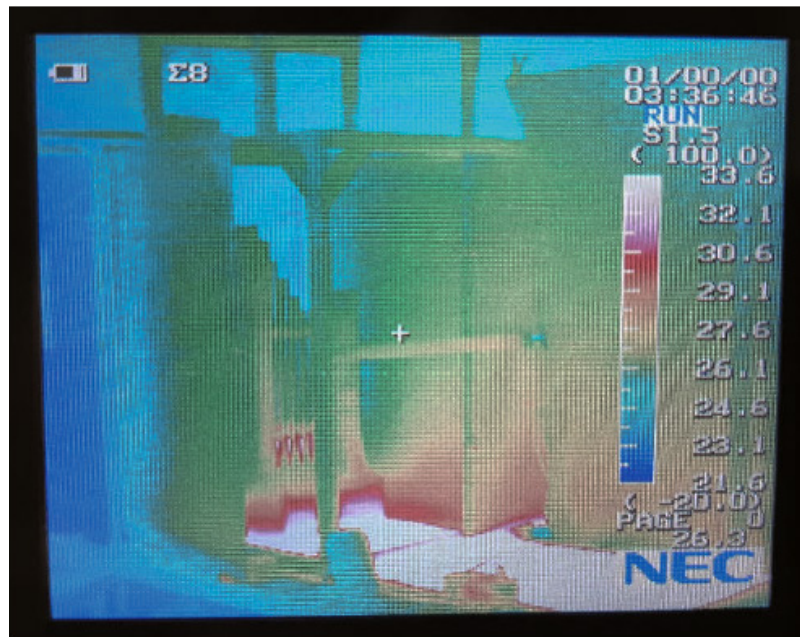
Abb. 46 Versuchsanordnung zur Wirkung eines Heizteppichs. Die Thermographie zeigt, dass die Oberflächen der Modellorgel und ihres Gehäuses bei mehrstündigem Betrieb des Teppichs im Bereich von 26,5 °C bis 33,6°C erwärmt werden.
