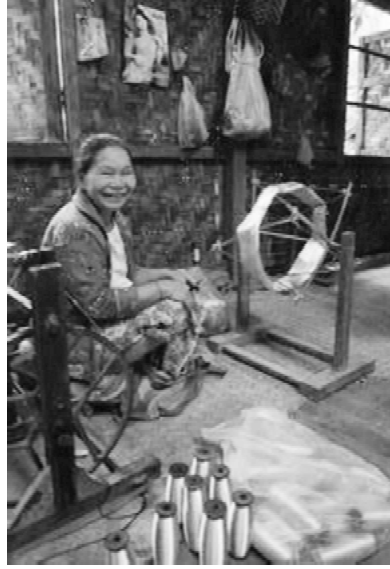
Abbildung 11: Eine Mitarbeiterin einer größeren Weberei spult Kettfäden auf
