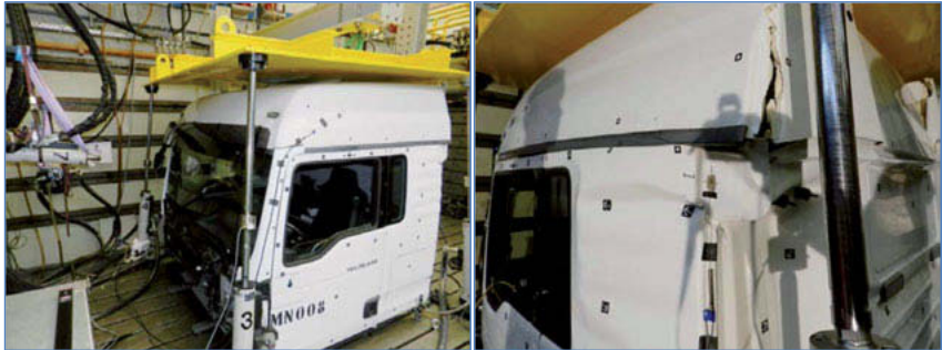
Bild 14: Erster Komponententest mit festverankerter Karosserie
