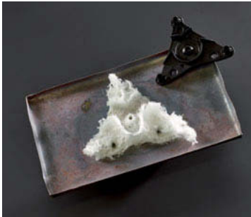
Bild 5: Gehäuse (Rechts) und Faseranteil nach dem Veraschen (Mitte).
