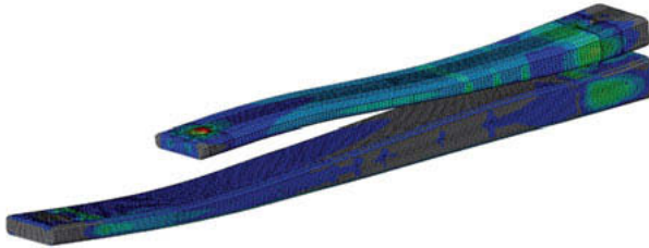
Bild 6: FEM-Analyse der GFK-X-Achse
