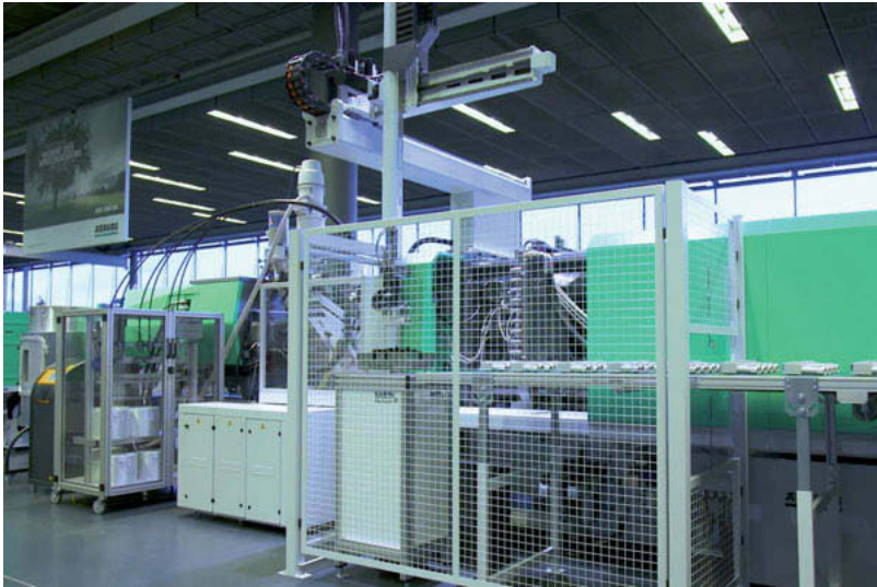
Bild 5: Produktionszelle mit FDC-Einheit sowie automatisiertem Handling und Wiegen der faserverstärkten Bauteile. Bild: ARBURG GmbH + Co KG.
