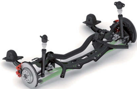
Bild 7: Zusammenbau der GFK-X-Achse [1]
