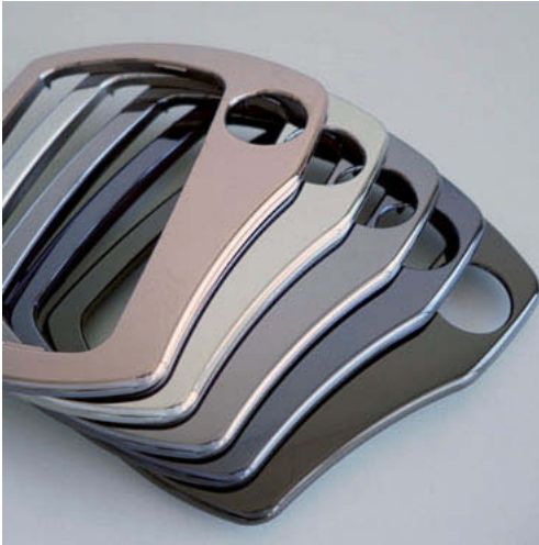
Bild 1: HiPIMS für die Veredlung von Kunststoffen, Quelle: Kunststoff-Institut Lüdenscheid GmbH
