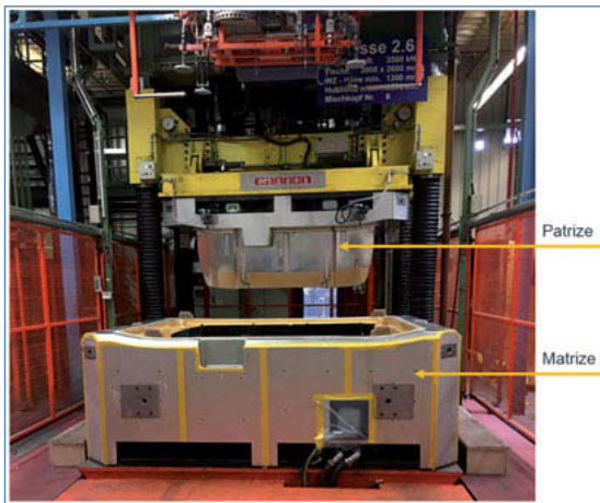
Bild 10: RTM-Werkzeug mit 100%-Nickeloberfläche
