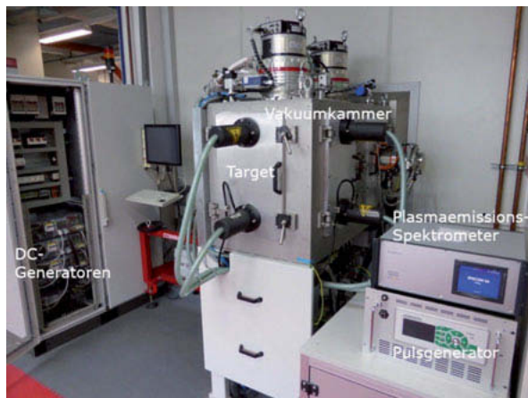
Bild 3: Mit einem Pulsgenerator (MP 2 der Fa. Magpul) und Plasmaemissionspektrometer (Emicon der Fa. Plasus) aufgerüstete HiPIMS-Anlage am Kunststoff-Institut Lüdenscheid, Quelle: Kunststoff-Institut Lüdenscheid GmbH
