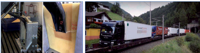
Bild 17: Erprobung Anbindung Aeropaket (neu und gealtert); Bahnrückwärtsverladung
