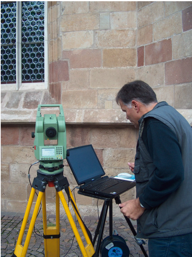
Bild 2 Messung mit dem Tachy- meter mit direkter Beob- achtung am Objekt und online-Kartierung
