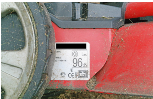
Bild 9 Rasenmäher benötigen nach der Maschinenlärmverordnung (32. BImSchV) die Angabe des Schallleistungspegels. Für das abgebildete Gerät werden 96 dB angegeben.
