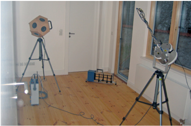
Bild 41 Messung der Luft- und Trittschalldämmung in einem Raum
