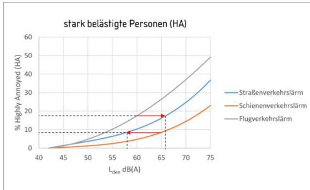
Bild 82 Prinzipielles Vorgehen entsprechend Richtlinie VDI 3722-2 zur Berechnung des Summenpegels bei Überlagerung von unterschiedlichen Verkehrslärmquellen
