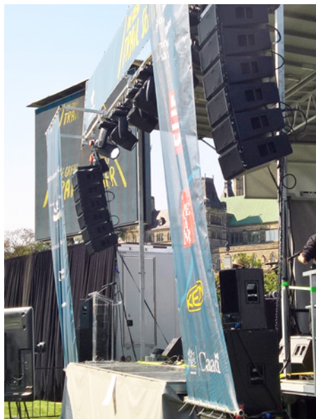
Bild 7 In der Veranstaltungstechnik werden mehrere Lautsprecher zu einem »Line Array« zusammengefasst. Als Linienschallquelle wird dann eine zylindrische Schallabstrahlung erreicht. Bei der abgebildeten Musikbühne werden zwei Line Arrays aus jeweils sechs Lautsprecherboxen verwendet.
