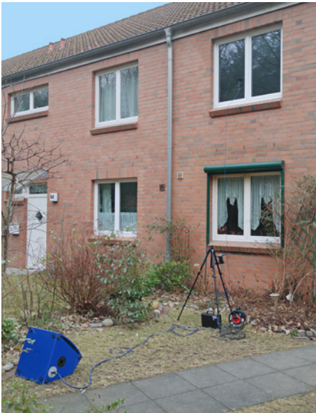
Bild 43 Messung der Fassadenschalldämmung eines Fensters im Obergeschoss eines Wohngebäudes mit einem Flächenlautsprecher (blau) in normgemäßer Ausrichtung. Zur Sicherstellung des erforderlichen Beschallungswinkels kann für Bauteile in größerer Höhe auch ein Hilfsgerüst erforderlich sein.
