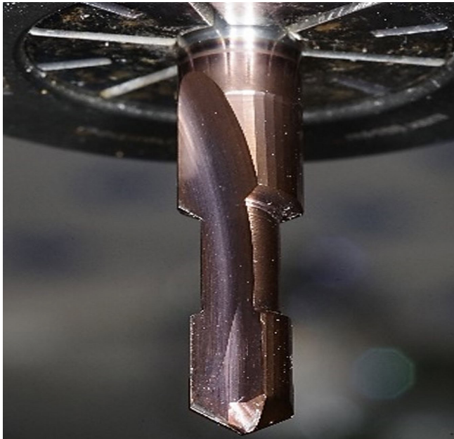
Bild 1. Gefertigtes Stufenbohrwerkzeug. Foto: FGW
