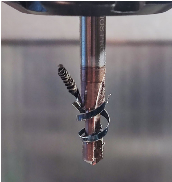
Bild 3. Links: Bandspanbildung am Werkzeug. Rechts: resultierende Beschädigung des GFK (glasfaserverstärkter Kunststoff). Foto: FGW
