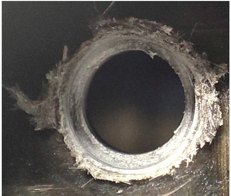
Bild 3. Links: Bandspanbildung am Werkzeug. Rechts: resultierende Beschädigung des GFK (glasfaserverstärkter Kunststoff). Foto: FGW
