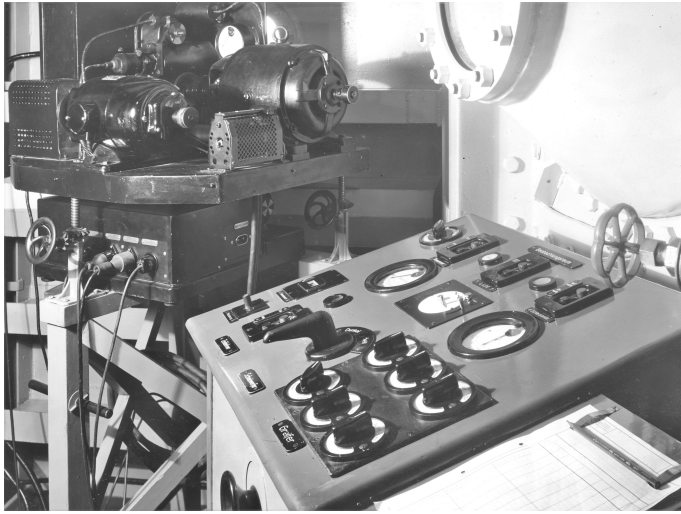
Abb. 3: Steuerpult im Trudelwindkanal mit Knöpfen und Reglern zur Steuerung der Schleusentür, der Scheinwerfer, des Greifers für die Modelle und des Zeitdehners. Bildquelle: Krüger: Der Überdruck-Trudelwindkanal der DVL, o.S.
