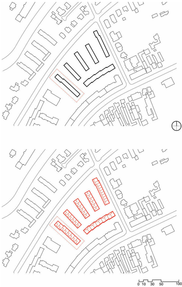
Abb. 16: Lagepläne Bestand – Nachverdichtung, Bebelallee
