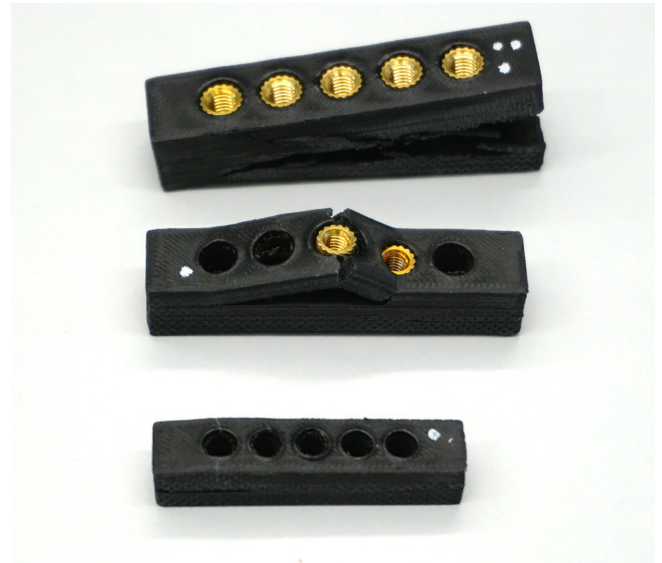
Bild 7. Zerstörte Bauteile M3 (unten), M4 (Mitte) und M5 (oben) mit Versagen der Zwischenschichthaftung. Foto: Fraunhofer IPA
