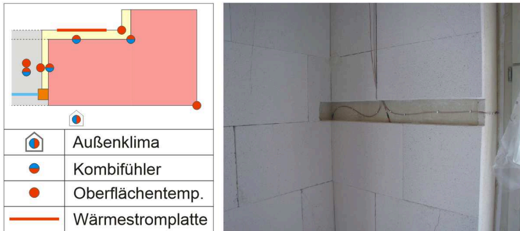
Abbildung 4: Prinzipskizze einer Messstrecke (links) und Einbau der Kombifühler hinter der Innendämmung (rechts)
