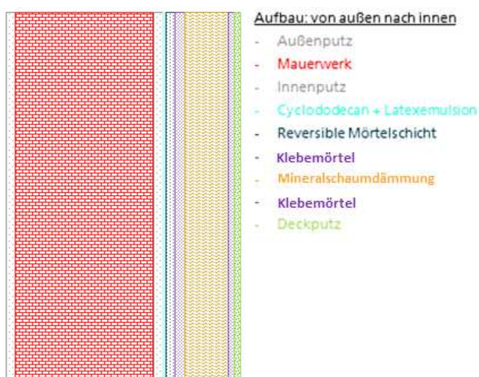
Abbildung 4: In WUFI®-2D implementierter Wandaufbau am Beispiel der Mineralschaumdämmung.
