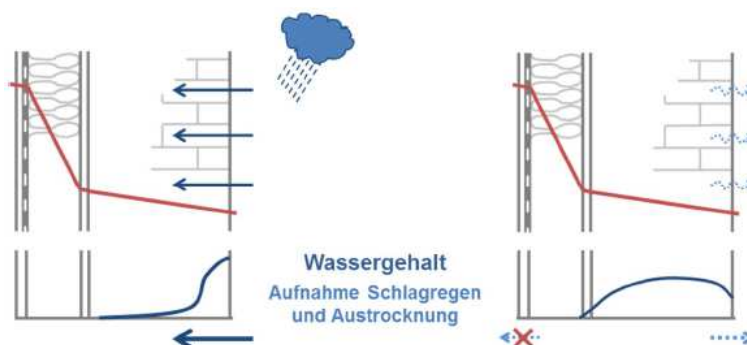
Abbildung 4 Auswirkung der Innendämmung auf eine Sichtmauerwerkskonstruktion in Bezug auf die Schlagregenaufnahme und das Austrocknungsvermögen
