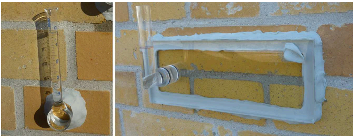
Abbildung 2: Wassereindringprüfer nach Karsten (links) und WD Prüfplatte nach Franke (rechts)
