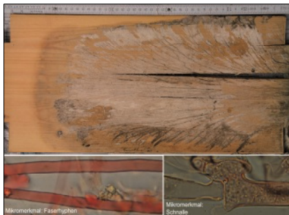
Abb. 5: Nicht einbezogene Bereiche und Schadorte an Möbeln, auf Decken aus Beton etc.; Bild zeigt ein Regalbrett mit Befall durch Echten Hausschwamm.
