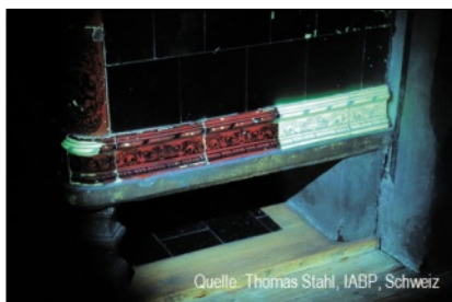
Fluoreszenzbild offenbart die Reparaturstellen
