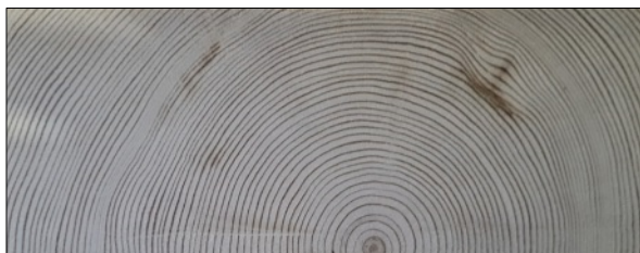
Abb. 17: Früh- und Spätholzanteil der sibirischen Lärche
