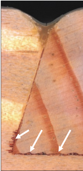
Abb. 2: Querschnitt der Brüstungsfuge einer Eckverbindung. Der mit Lugolscher Lösung braun gefärbte Klebstoff (Pfeile) fehlt im äußeren Teil der Fuge.
