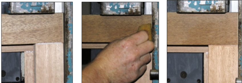
Abb. 1: Nur wenn beim Verpressen Klebstoff aus der Fuge dringt (siehe linkes Bild), kann von einer ordnungsgemäßen Verklebung ausgegangen werden. Besonders bei später lasierend behandelten Fenstern muss der Klebstoff äußerst sorgfältig abgewischt werden.
