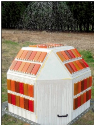
Abb. 2: Der mehrseitige Bewitterungsstand ermöglichte Dosisvariationen in der Freilandbewitterung, einige waren mit zusätzlichen Wassersprüh- und Heizeinrichtungen ausgestattet; Ergebnisse der Glanzhaltung einer wasserbasierten Beschichtung, 3 Anstriche nach 9 Monaten Bewitterung (Bilder: PRA)
