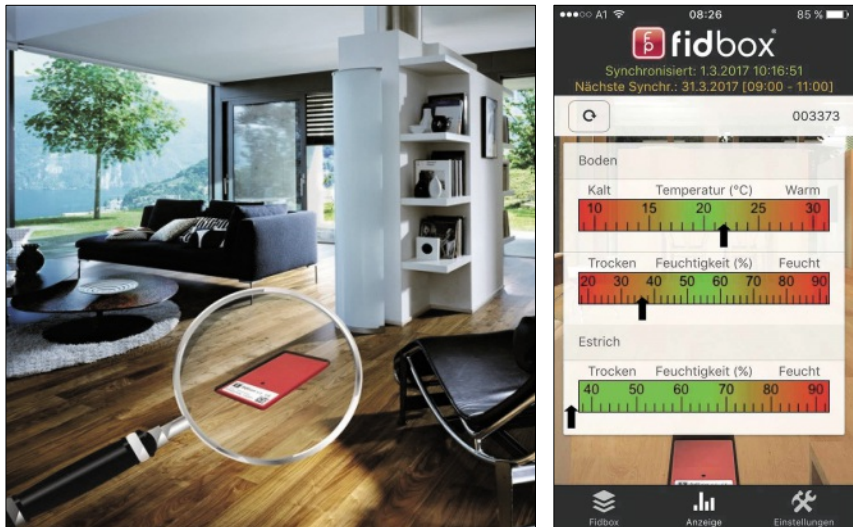
Abb. 10: Fidbox – auslesbarer Datenchip in der Fußbodenkonstruktion
