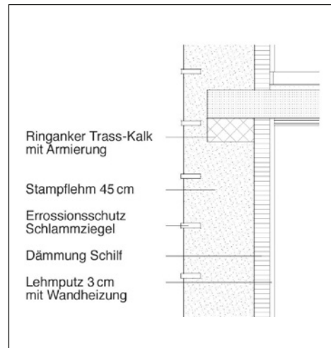
Abb. 88: Schnitt durch den »monolithischen« Wandaufbau aus Stampflehm, Schlammziegeln als Erosionsschutz und der Innendämmung aus Schilf des Wohnhauses Rauch (Quelle: Boltshauser Architekten).
