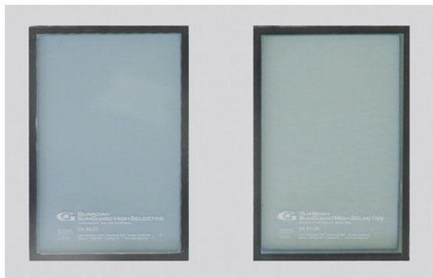
Abb. 107: Glasfärbungen bei unterschiedlich starker Sonnenschutzverglasung mit einem niedrigen g-Wert
