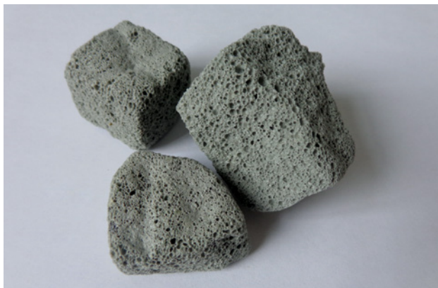
Abb. 74: Aufgeschäumter Glasschotter als Dämmstoff und Zuschlagstoff für Leichtbetone
