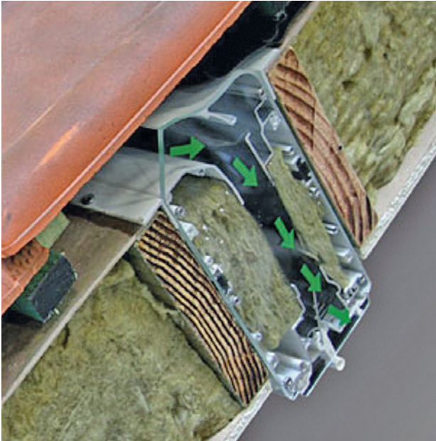
Abb. 140: Einfaches Lüfterelement für den Einbau im Dachbereich als Bauteil einer Lüftungsanlage nach DIN 1946-6. Die Luft strömt unterhalb der Dachpfannen zum Lüftungsschlitz (Quelle: Fa. Renson).
