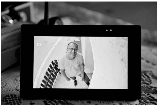
Abbildung 6: Mobiles Tablet und Videokamera integriert mit Türöffnung
