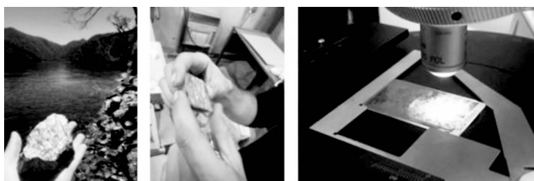
Figura 12: Fotografías de la trayectoria de una muestra de roca para el estudio de su textura. En las imágenes se puede apreciar el viaje de la roca desde la misma traza de la falla geológica en terreno, la cadena de reducción y finalmente la observación bajo la luz del microscopio; Elaboración propia (2019).
