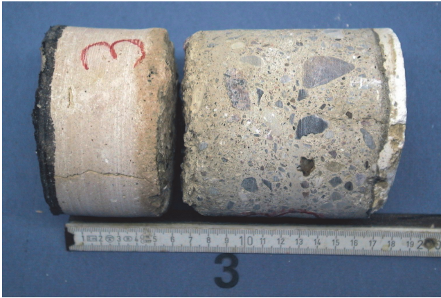
Bild 1 Bohrkern aus der Deckenkonstruktion (Foto von Barg Betontechnik – Berlin)
