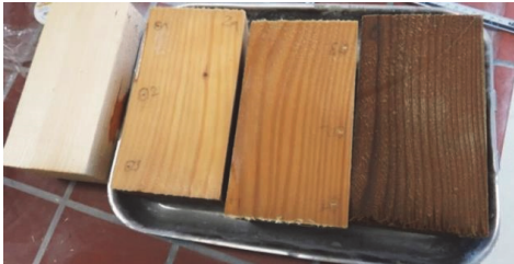
Bild 15 Verfärbung des Fichtenholzes (v.l.n.r.): trocken, in Wasser, Ammoniumhydroxid pH=10 bzw. 12 gelagert
