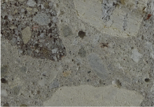
Bild 9 Gefügedetail eines R-Betons C25/30 mit Typ 1 Körnung (links oben)
