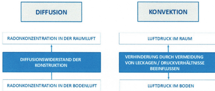
Bild 5 Prinzipielle Darstellung der Transportprozesse radonhaltiger Bodenluft zwischen Erdreich und Gebäudeinnerem
