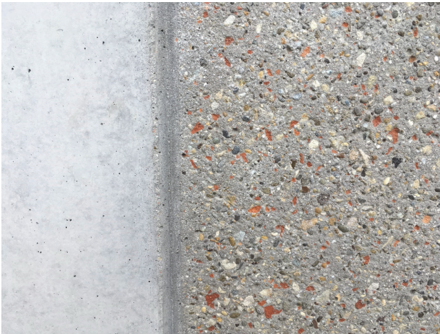
Bild 11 links geschalte Oberfläche, rechts gesandstrahlte, buntkörnige Oberfläche eines R-Betons mit Typ 2-Körnung
