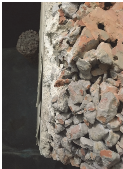
Bild 4 Originalstück des Schüttschutts, im wesentlichen Ziegelsplitt
