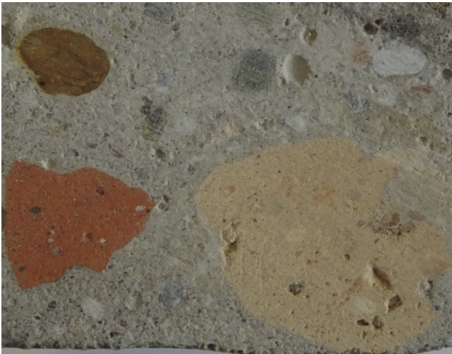
Bild 10 Gefügedetail eines R-Betons C25/30 mit Typ 2 Körnung (verschieden farbiger Ziegelbruch)
