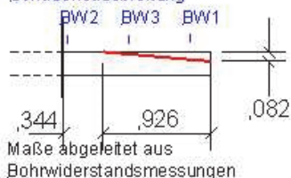
Bild 3 Schnittskizze der am weitesten reichenden Fäulniszone an der Balkenoberseite (oben) und Abgrenzung der Fäulniszonen an den Balkenköpfen, korrelierend zum Dachüberstand (unten)
