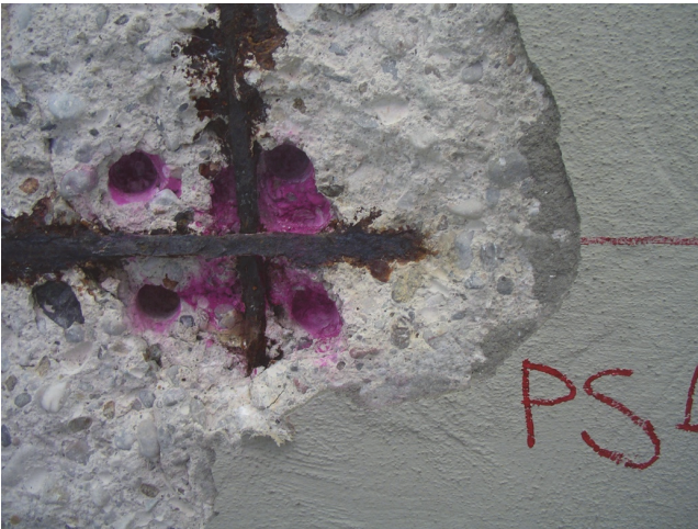
Bild 4 Nachweis der Karbonatisierungstiefe mit 0,1%-iger Phenolphthaleinlösung, nicht karbonatisierte Bereiche verfärben sich rot-violett [8].
