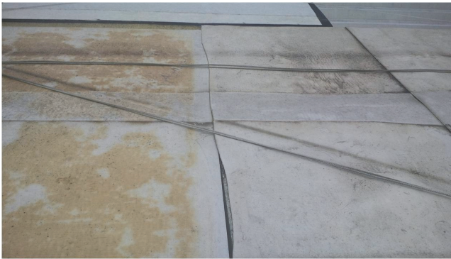
Bild 7 FPO auf einer neuwertigen Bitumenlage in der Bewitterung (rechts mit und links ohne Trennlage)
