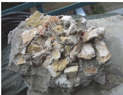
Bild 21 Ziegelsplittbeton vor dem Balkenkopf mit Myzel durchwachsen
