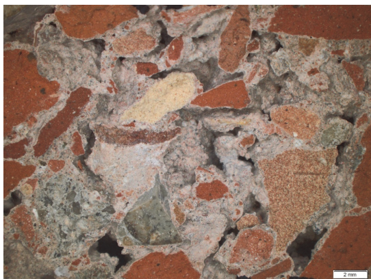
Bild 7 Vergrößertes Detail eines Leichtbetonsteins mit Trümmerschutt
