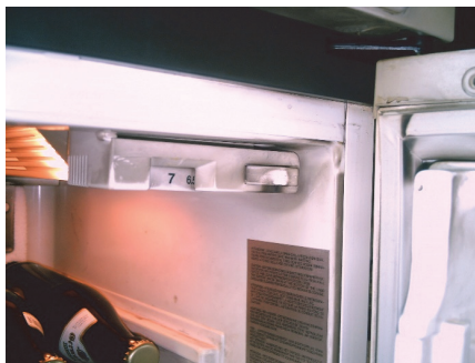
Bild 6 Foggingspuren im Kühlschrank
