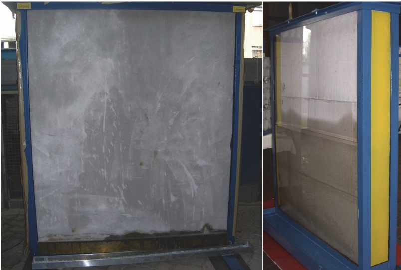
Bild 4 Vorder- und Seitenansicht der Demonstratorwand des nachträglichen Abdichtungssystems aus Textilbeton [3]
