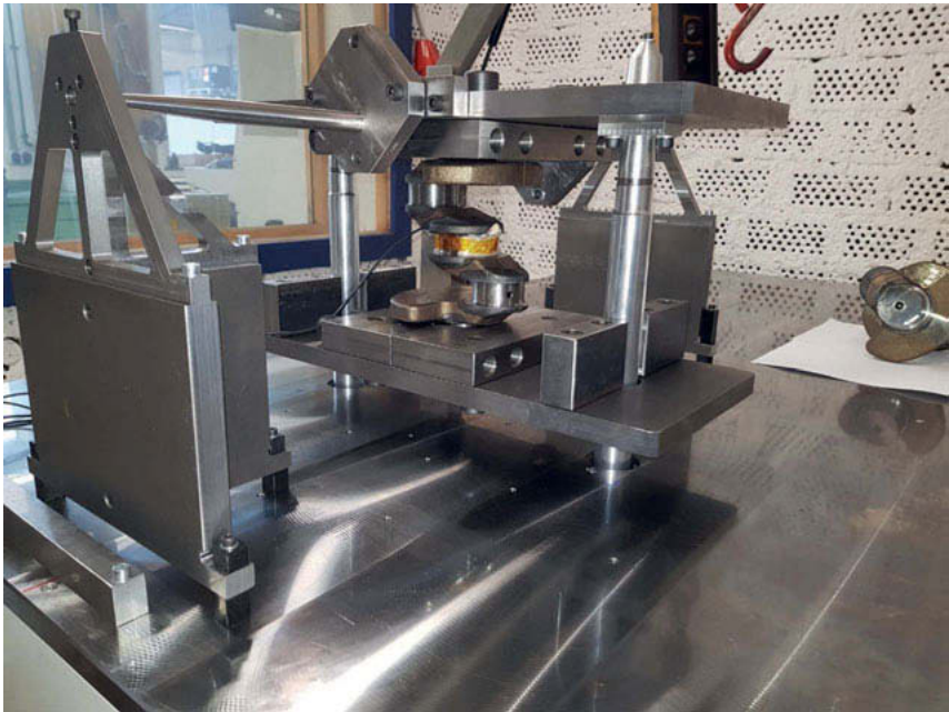
Bild 6: Biege – und Torsionsresonanzprüfstand bei Hatz Aufbau für Biegeprüfung
