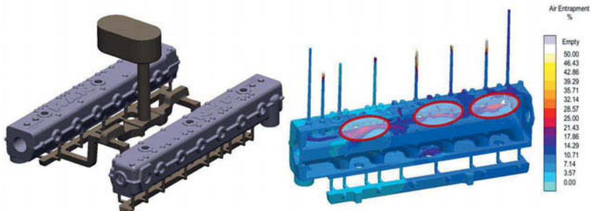
Bild 12: Luftpneinschlüsse in einem Abgasrohr aus GJL-250
