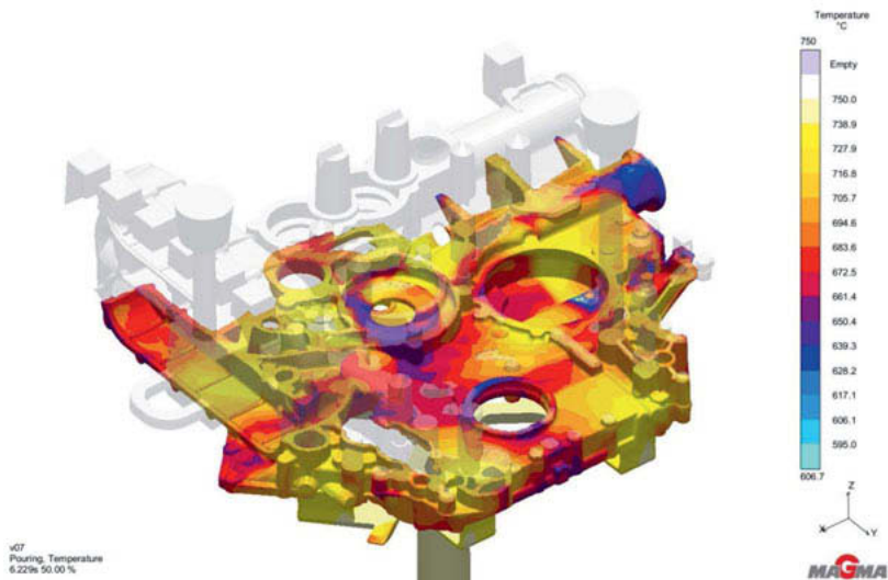
Bild 5: Formfüllungssimulation vom Aggregateträger bei 50%iger Befüllung vom Formhohlraum.
