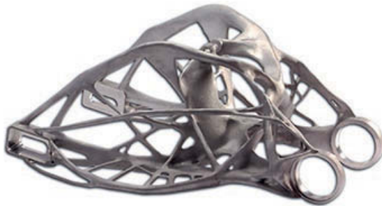
Bild 7: Motorradschwinge "Casting of the Year" des amerikanischen Giesserei- verbandes AFS und der Zeitschrift Metal Casting Design & Purchasing [11]
