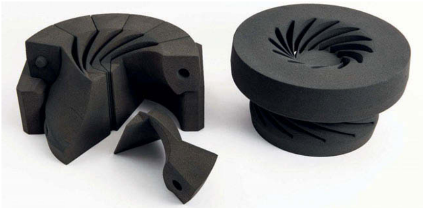
Bild 3: Impeller - geklebt versus geprintet (Voxeljet, Friedberg)
