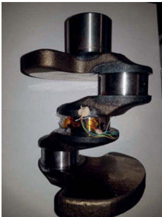
Bild 7: Mit DMS applizierter Wellenabschnitt zur Biegeresonanzprüfung
