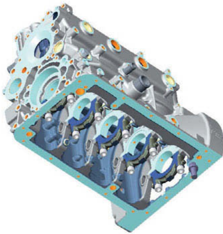
Bild 5: Blick von unten auf das Kurbelgehäuse des 4H50 und die geschlossene Dichtkontur der Ölwanne.
