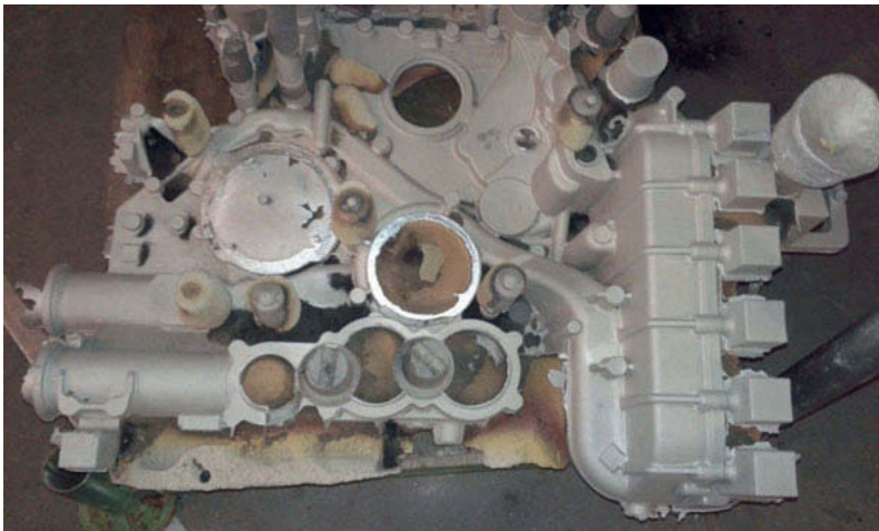
Bild 8: Sicht auf den vom Oberkasten geformten Bereich des Aggregateträgers
