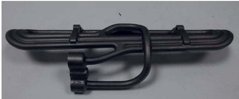
Bild 12: Additiv-hergestellte Hydraulikkomponente aus Titan
