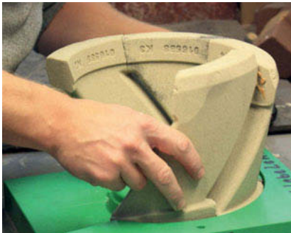
Bild 1: Fügen eines Kernpakets aus 7 unterschiedlichen Segmenten in einer Kleblehre
