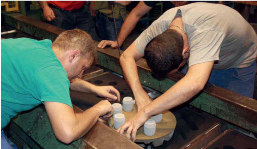
Bild 5: Jedes Mal „ein kleines Abenteuer“ - das erste Einlegen eines geprinteten Kerns
