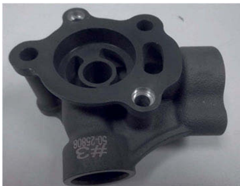
Bild 1: Ölpumpengehäuse aus Aluminium (3D gedruckt mit schwarz eloxierter Oberfläche), das Teil scheint i.O.
