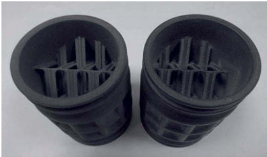
Bild 4: Luft-Einlass-Diffusor hergestellt aus zwei verschiedenen Kunststoffarten mit demselben 3D Druckverfahren.
