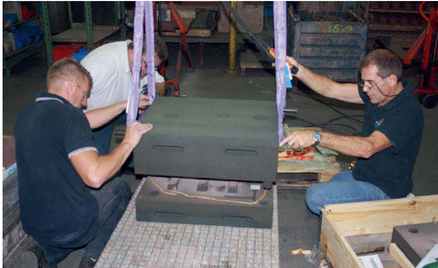
Bild 9: Zusammenlegen einer Print-Form mit dem Kernpaket vor dem Abguss
