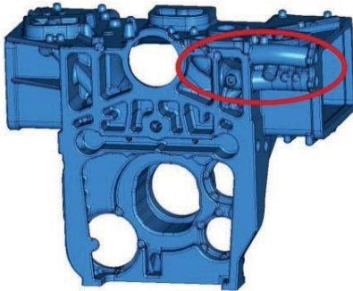
Bild 3: Integrated Front End (IFE) für einen GE L250 Inline Marinediesel, Sphäroguss (GJS 400), Gussgewicht 3.100kg. In dem rot markierten Bereich liegen integrierte Kühlwasserrohre.
