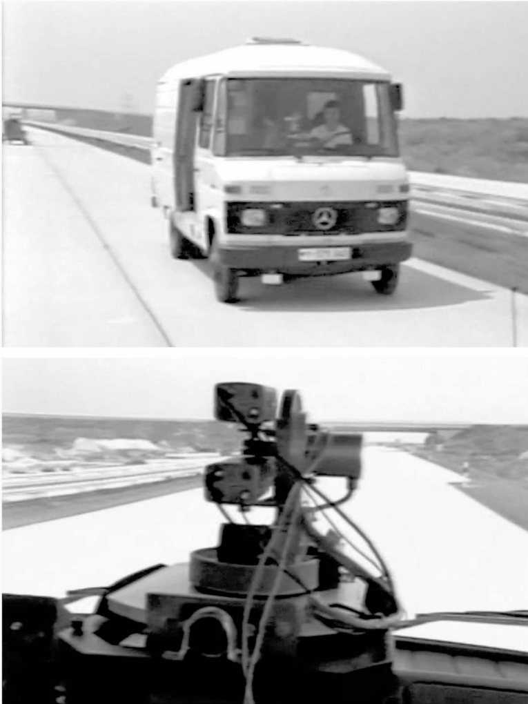
Abbildung 2: Die Kameraplattform im Versuchsfahrzeug für autonome Mobilität und Rechnersehen (VaMoRs) 1986
