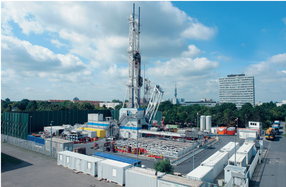
■ Abb. 13: Eine lärmarme Bohranlage in Hannover
