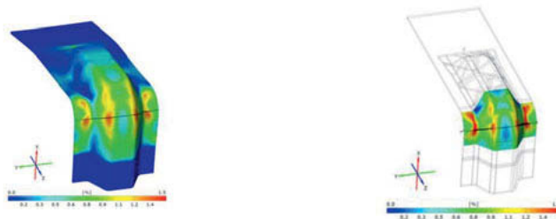
Bild 8: Vergleich der Hauptformänderung in ANSYS (links) und ARAMIS (rechts)
