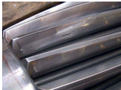
Durch Überlastung im Prototypenversuch erzeugter Schaden
