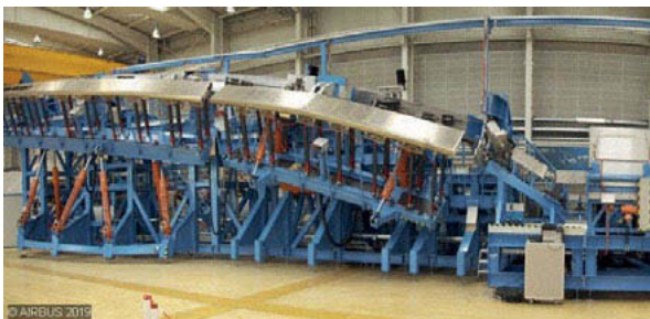
Bild 2: Teststand des A 380 Auftriebssystems mit Lastzylindern zur Simulation der Position und der Luftlast.
