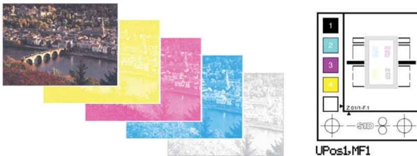
Bild 4: Darstellung der vier Farbauszüge (Schwarz, Cyan, Magenta, Gelb) und des Gesamtbildes (links), vergrößerte Darstellung eines SID-Messfelds (rechts)
