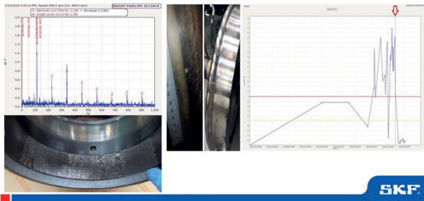
Abb. 4: Beispiele für erkannte Rad- und Lagerschäden
