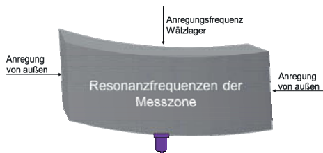
Bild 6: Messzone der Continuous Motion-Maschine an welcher der Sensor angebracht ist
