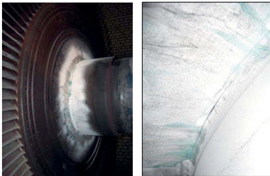
Bild 7: Vorgefundener Umfangsriss im Durchmesserübergang zur ND-Endstufe
