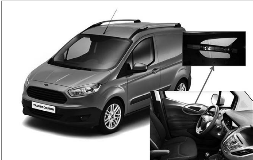
Bild 8: „Lokale Verstärkung“ in der Türinnenverkleidung des Ford Transit Courier B460 (Source: Ford Motor Company)
