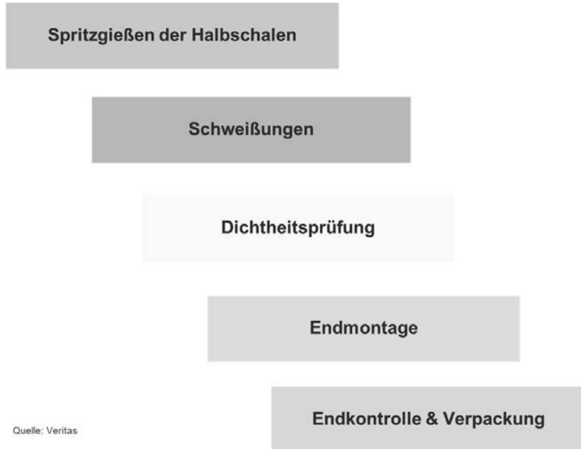
Bild 7: Darstellung der Prozessschritte der Tankfertigung
