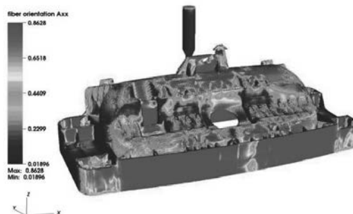
Bild 18: A_{xx} Komponente des Faserorientierungstensors nach der Füllung des Airbaggehäuses.
