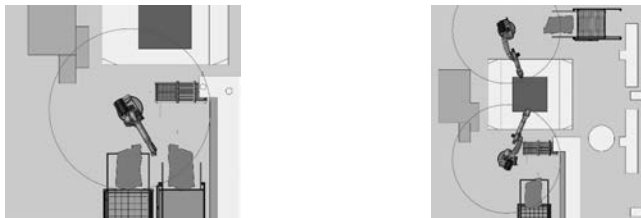
Bild 5: Zuführungskonzepte mit einem (links) und zwei Robotern (rechts)
