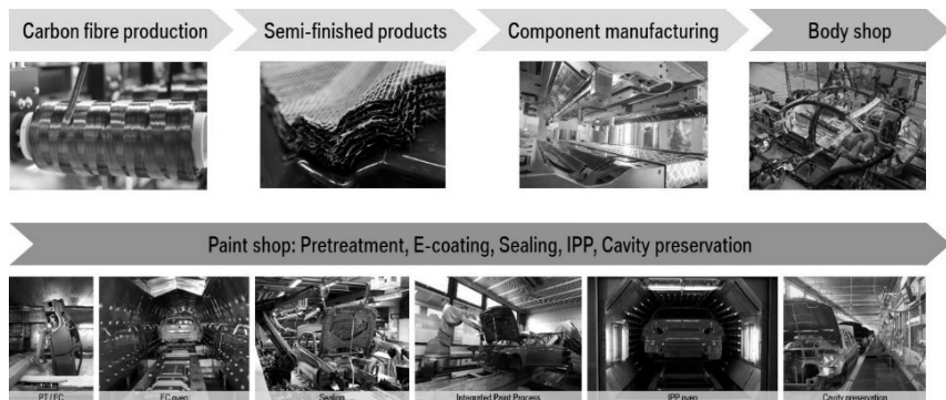
Bild 4: Prozesskette für wärmhärtende Klebstoffe im Carbon Core Produktionskonzept [4]
