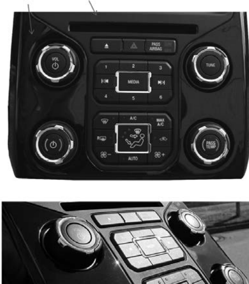
Bild 5: Komplexe Schalterblende als Demonstrator (Skintec® Firma Kostal, Bild: Kostal)
