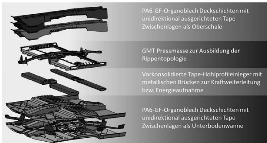
Bild 3: Detailaufbau des finalen Konstruktionsstandes
