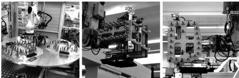
Bild 10: links: Rundschartisch für die Buchsenaufnahme; mittig und rechts: Bestückungs- und Entnahmehandling düsen- und auswerferseitig.
