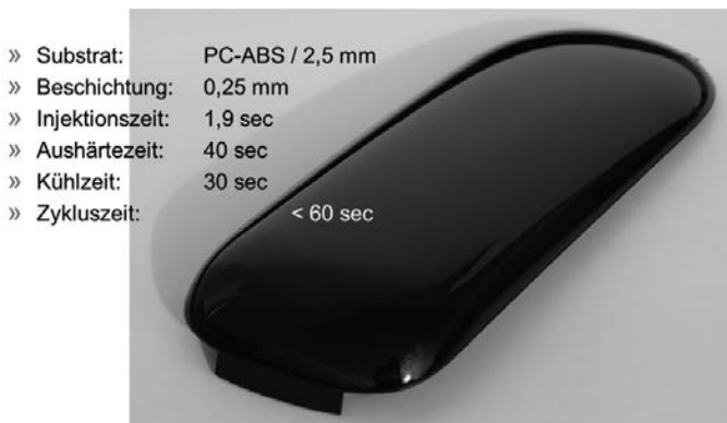
Bild 3: Hochwertige Piano-Black-Optik im Spritzguss durch Überfluten mit puroclear®
