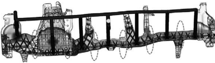
Bild 6: Hauptbindenähte an der Oberfläche geschlossen, weiteres Durchspülen wg. fehlender Formfüllung → Bindenähte werden im Kern verschoben.
