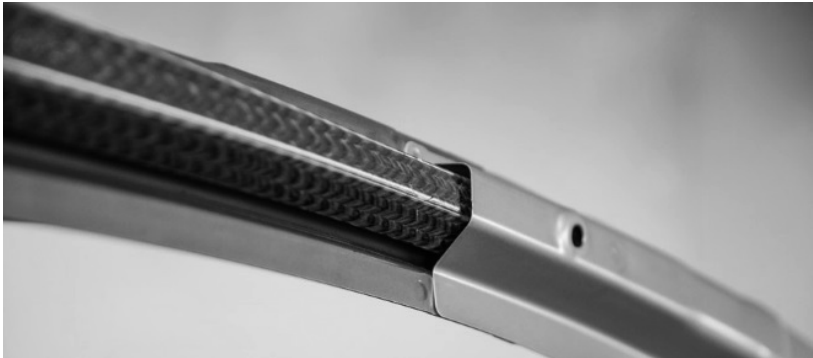
Bild 9: RTM-Flechtbauteil Verstärkung Dachrahmen
