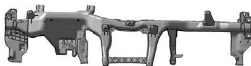
Bild 4: Variante 2 - Organosheet im Querverbund und mit Thermoplast hinter-spritzt
