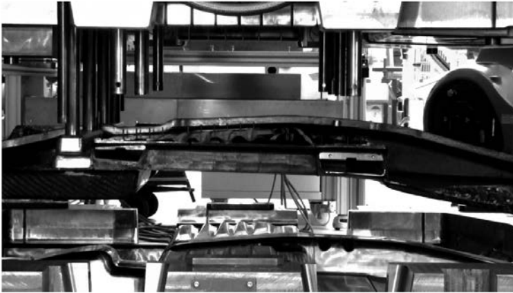
Bild 9: Seitliche Entformung des Bauteils aufgrund von Hinterschnitten notwendig
