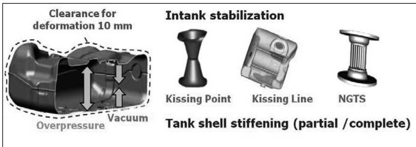
Bild 10: Situation Tankbegrenzung und Stabilisierungsmöglichkeiten
