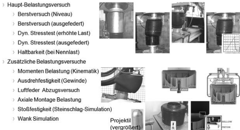
Bild 7: Versuche zur Verifizierung der Auslegungsergebnisse
