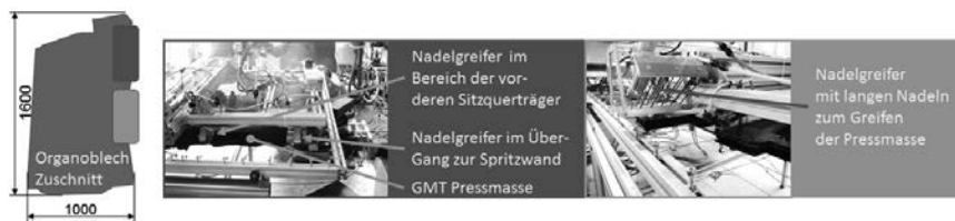
Bild 8: Darstellung des Handhabungskonzeptes an ausgewählten Positionen
