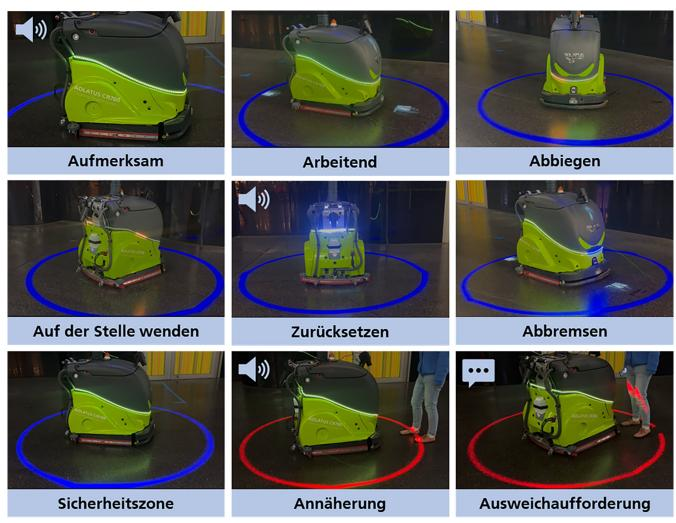
Bild 2. Fotos von der Implementierung der neun entwickelten Patterns auf dem CR700. Fotos: Fraunhofer IAO
