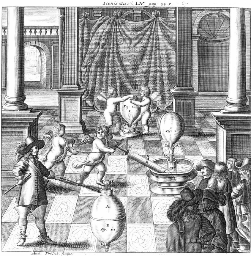
Abbildung 6: Vakuumversuche auf der Würzburger Festung Marienberg mit Ansaugpumpe und gläsernen »Rezipienten«, aus K. Schott, Mechanica hydraulico-pneumatica , Würzburg 1657.
