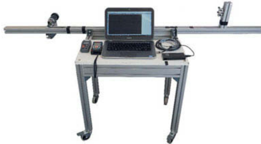
Bild 4: Tischaufbau mit angebrachtem Messsystem. Die Kamera (links) und zwei Lasermodule (rechts), sind auf Aluminiumprofilen in einer Distanz von 1,3m zueinander angebracht.
