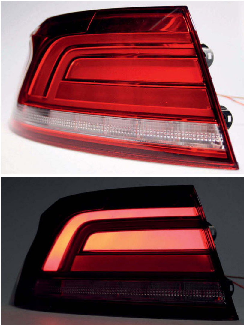
Bild 19: Modifizierte Serienleuchte mit integrierter Diffusoroptik
