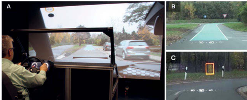
Bild 3: A) Versuchsaufbau im Fahrsimulator, B) Navigationshinweis, C) Objektwarnung.
