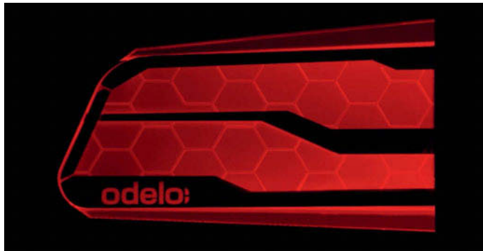
Bild 6: LED-Blade mit Strukturierung, Maskierung und schwarzem Separator zur Trennung in einen oberen und einen unteren Teilbereich.
