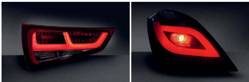
Bild 1: Heckleuchten mit DF-Material, links Serie Audi A1, rechts Prototyp
