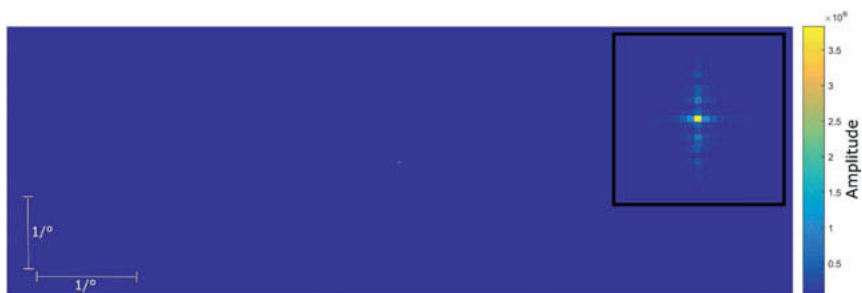
Bild 5: Zweidimensionale Fouriertransformation von Bild 4. Inset: 20-fache Vergrößerung des Zentrums der 2D-FFT. Amplitude der 2D-FFT als Farbskala in bel. Einheiten. Achsen im Fourierraum [1/^\circ] besitzen die reziproke Einheit des Realraums (Raumwinkel).
