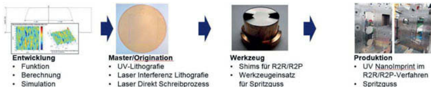
Bild 4: Prozesskette zur Erstellung von Bauteilen mit mikrooptischen Strukturen
