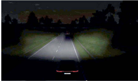
Bild 2: Visualisierung einer Ausblendungssituation mit der Matrix Lichtfunktion in VTD.
