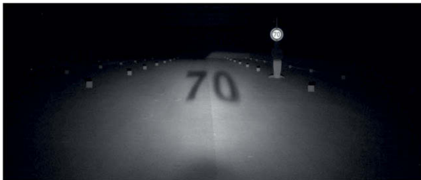
Bild 12: Einsatz des Prototyps zur Informationsprojektion bei Abblendlicht im Lichtkanal
