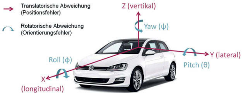
Bild 2: Positions- und Orientierungsfehler in Relation zum Fahrerblickpunkt (eigene Darstellung).
