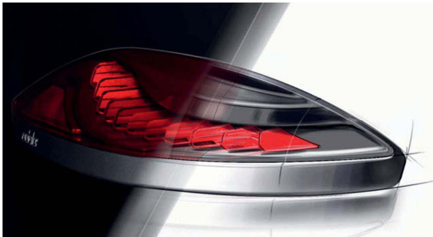
Bild 2: Von der Skizze (rechts) zur realen Musterleuchte (links), bei der die Schlusslichtfunktion mit LED-Blades umgesetzt ist. Bereits mit dieser einfachen Blade-Geometrie lässt sie den breiten Designspielraum der LED-Blades erahnen.
