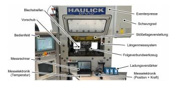
Bild 4 Vorversuchsaufbau der Exzenterpresse. Foto: IFUM
