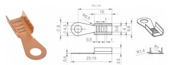
**Bild 1** Demonstratorbauteil (links) und technische Zeichnung mit Bemaßung in mm (rechts). *Grafik: IFUM*
