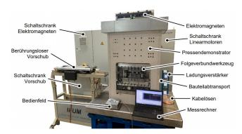
Bild 6 Versuchsaufbau der linearen Hybridpresse. Foto: IFUM
