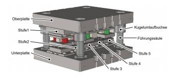
Bild 3 CAD-Konstruktion des Folgeverbundwerkzeuges. Grafik: IFUM
