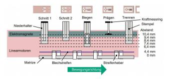
Bild 2 Schematischer Aufbau des Folgeverbundwerkzeugs mit den Stufeneingriffshöhen. *Grafik: IFUM*
