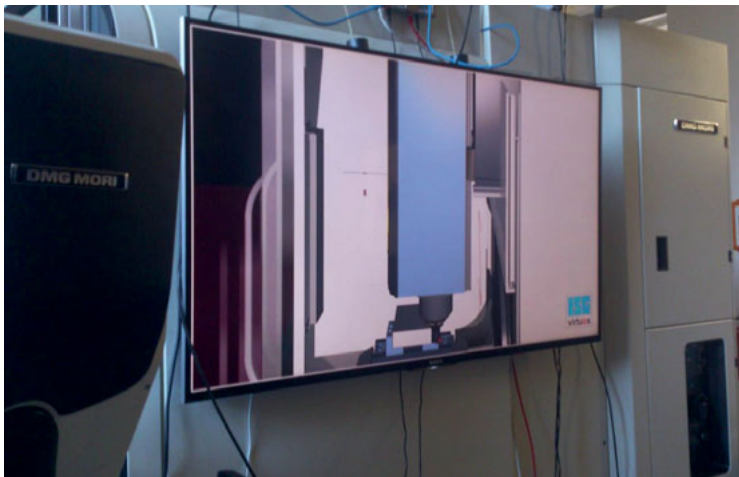
Abbildung 8-1: Nicht-transparentes Display seitlich der Werkzeugmaschine mit Möglichkeit des Einsatzes virtueller Realität durch Verwendung einer Shutter-Brille (Quelle: ModuleWorks)
