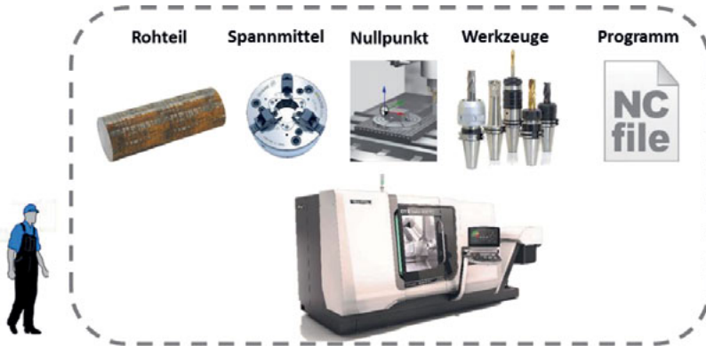
Abbildung 1-1: Maschineneinrichter verantworten die korrekte Kombination von Fertigungsmitteln in der Maschine (Quelle: DMG MORI)
