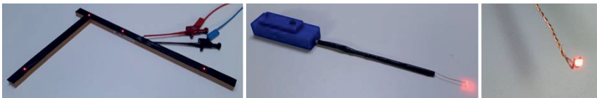
Abbildung 7-22: Kalibrierwinkel (links), Kalibrierpointer (Mitte), LED des Kalibrierpointers (rechts) (Quelle: HLRS)
