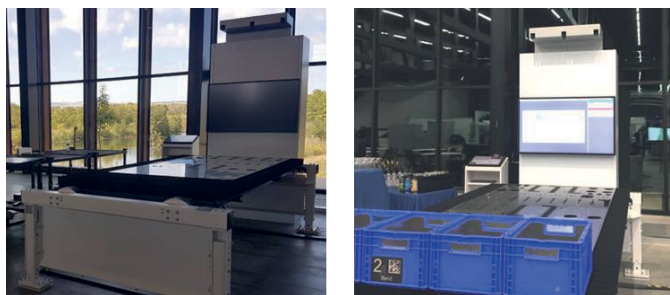
Abbildung 2-5: Im TRUMPF Showroom Smart Factory Chicago aufgestellter Absortierassistent mit drei Kameras und schräger Perspektive. (Quelle: TRUMPF)
