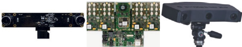
Abbildung 10-1: Stereokamera oCamS-1CGN-U (links), ToF-Kamera (Mitte), Structured Light Scanner (rechts) (Quelle: [1,2,3])
