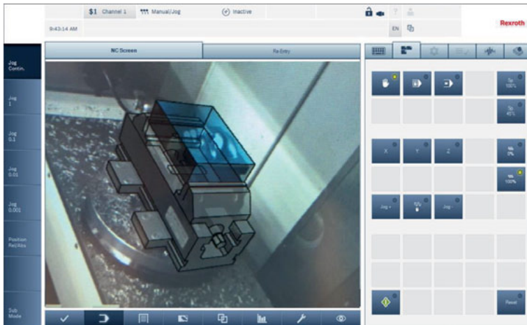
Abbildung 2-8: Überlagerung von NC-Simulation und Kamerabild integriert in die Benutzeroberfläche IndraWorks Operation (Quelle: Bosch Rexroth AG)
