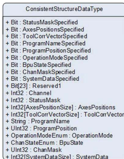
Abbildung 5-5: OPC UA Datentyp für die Übertragung der Echtzeitdaten in zeitlich konsistenter Form (Quelle: Bosch Rexroth AG)
