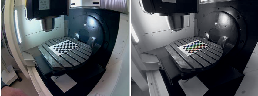
Abbildung 7-15: Verzerres und entzerrtes Kamerabild mit Schachbrett in DMU50 ecoMill (Quelle: HLRS)
