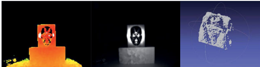
Abbildung 10-6: ToF-Testaufnahme (Tiefenbild links, IR Mitte) und 3D-Rekonstruktion (rechts) eines gefrästen Testobjekts (Quelle: HLRS)
