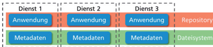
Abbildung 4-7: Zusammensetzung eines Dienstes (Quelle: ISW)
