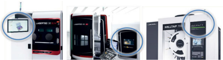
Abbildung 1-2: Zusätzliche Anzeigen als Informationskanäle zum Maschinenbediener (Quelle: DMG MORI)
