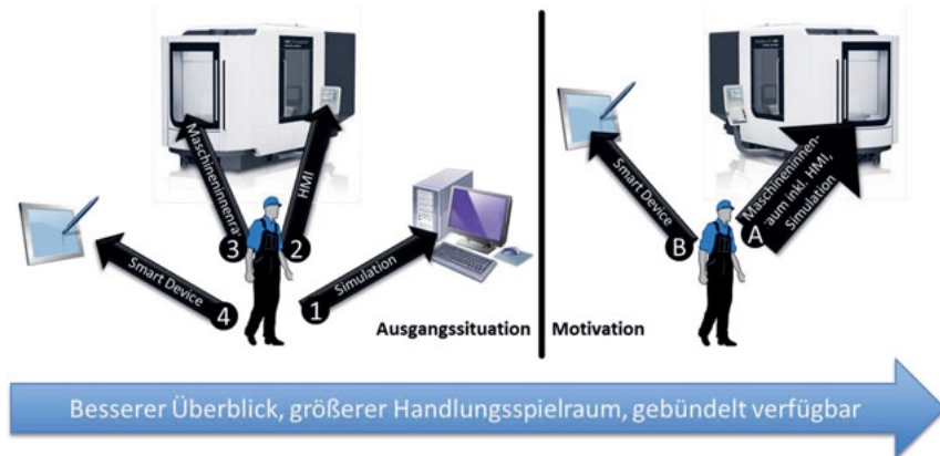
Abbildung 1-4: Das intelligente Maschinenfenster konsolidiert Informationskanäle zum Bediener
