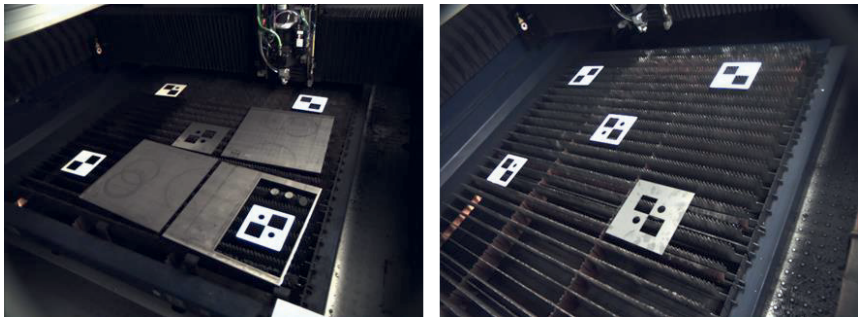
Abbildung 7-17: Marker in TRUMPF Werkzeugmaschine (Quelle: TRUMPF & HLRS)
