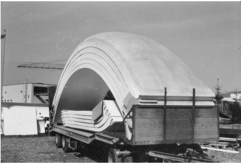
Abbildung 14: Die vorfabrizierten Schalelemente aus Kunststoff, 1983. 73
